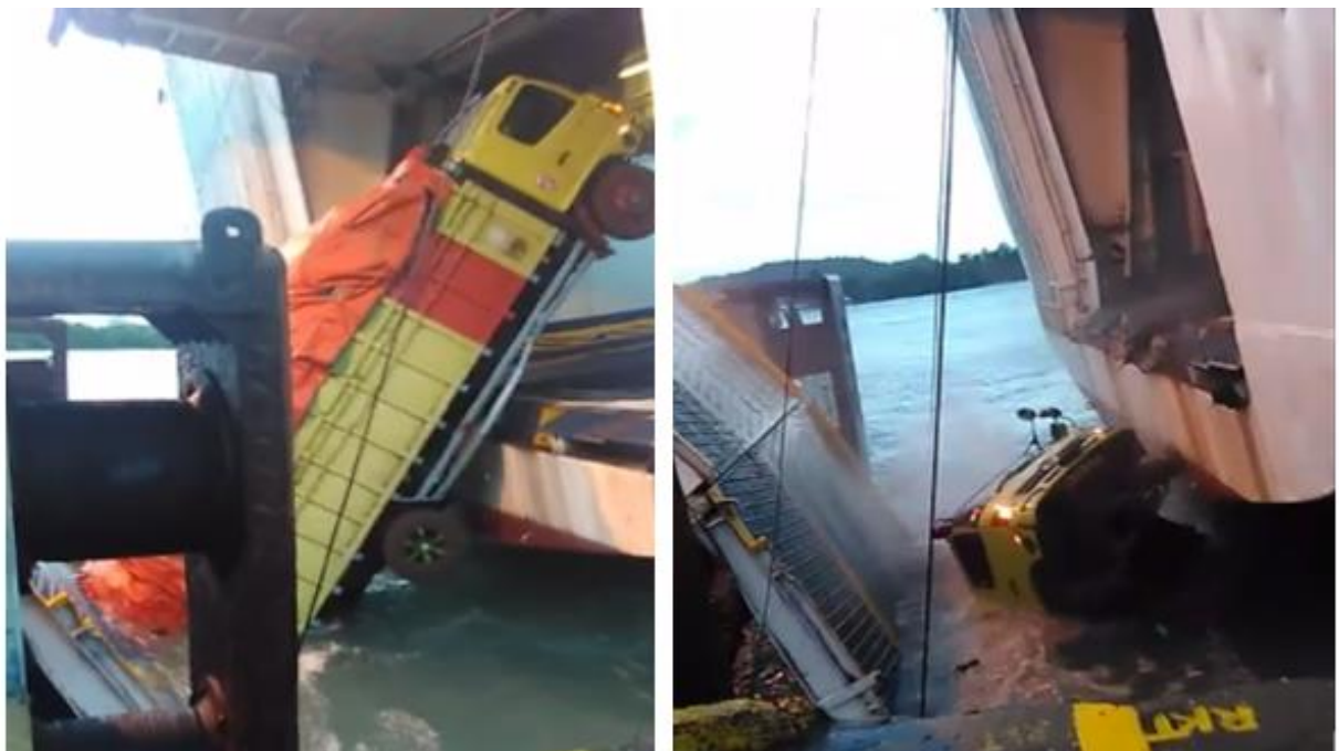
Gambar I-1: Pintu rampa buritan patah dan truk besar jatuh ke laut
