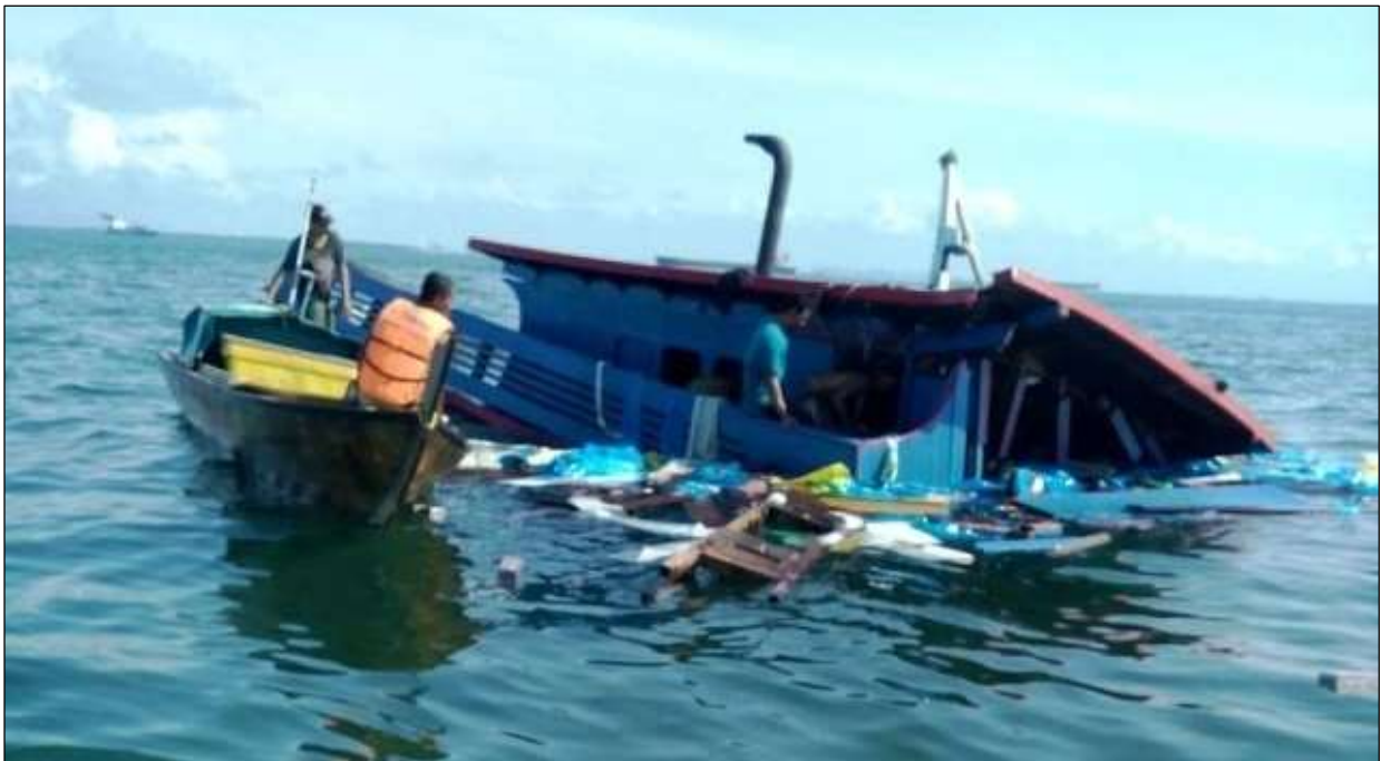
Gambar 3: Kondisi Makmur setelah tubrukan terpecah menjadi dua bagian
