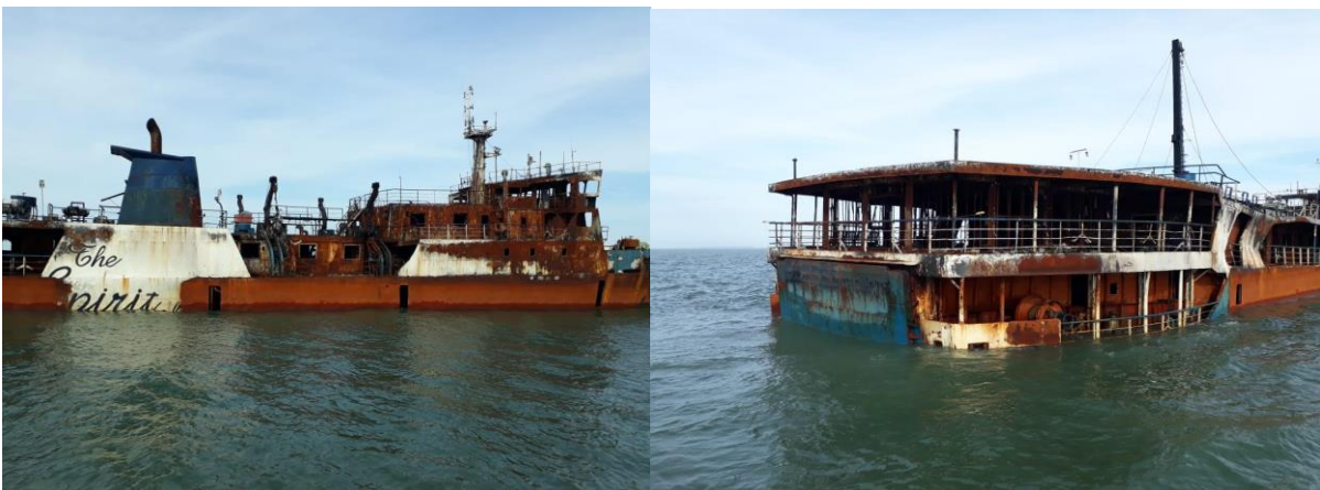
Gambar II-3: Kondisi Gerbang Samudra I Dengan Geladak Kendaraan Dalam Kondisi Hampir Tenggelam Akibat Kemasukan Air Laut Dan Hujan
