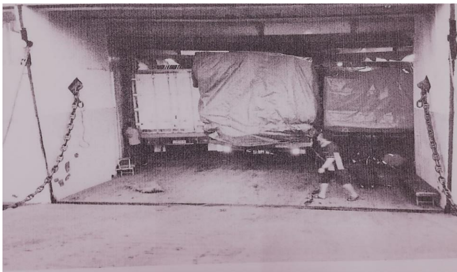
Gambar II-6: Jarak Antara Truk Yang Berdekatan/Berhimpitan di Pintu Rampa Buritan (Foto Sebelum Kapal Bertolak Tanggal 2 Desember 2018)
