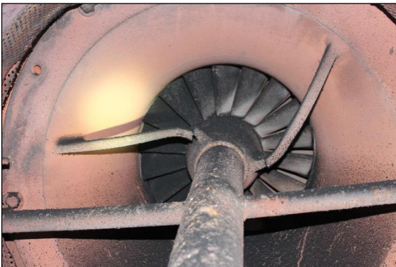
Gambar I-10: kerusakan pada bagian penahan dudukan bantalan poros turbine side (kompresor)
