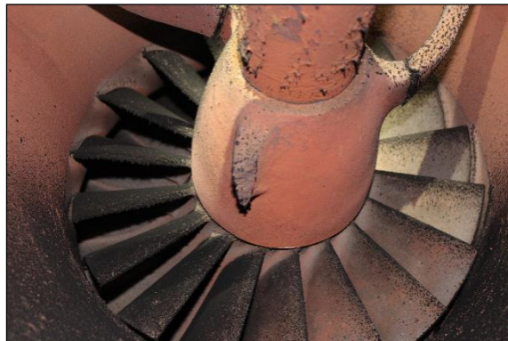
Gambar I-10: kerusakan pada bagian penahan dudukan bantalan poros turbine side (kompresor)
