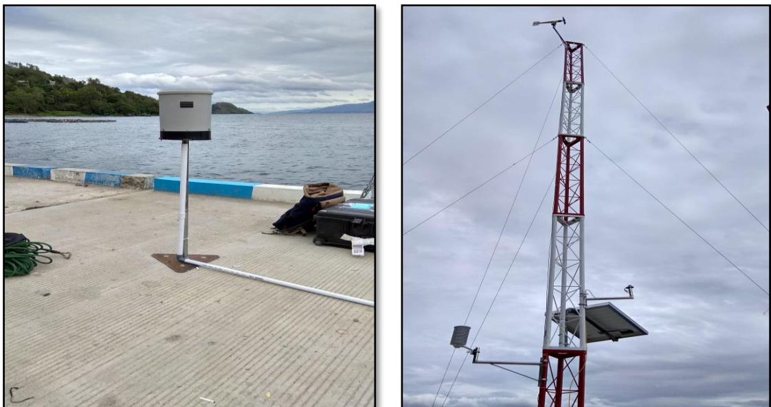
Gambar IV-1 : Pemasangan AWS di Pelabuhan Tigaras untuk monitor informasi cuaca di perairan Danau Toba
