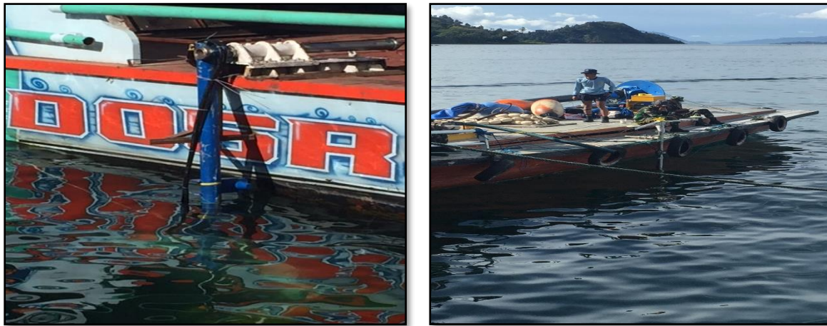
Gambar I-9: Pencarian bawah air dengan menggunakan Multi Beam dan Side Scan Sonar milik Basarnas dan Pushidros TNI AL.
