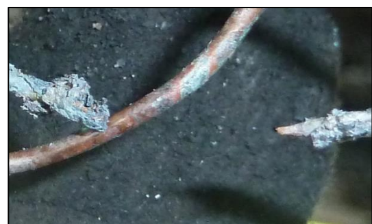
Gambar I-14 Karakteristik ujung inti kabel tembaga berbentuk runcing
