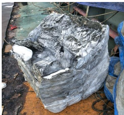
Gambar 7: Kondisi muatan styrofoam di Palka No. 2 yang terbakar
