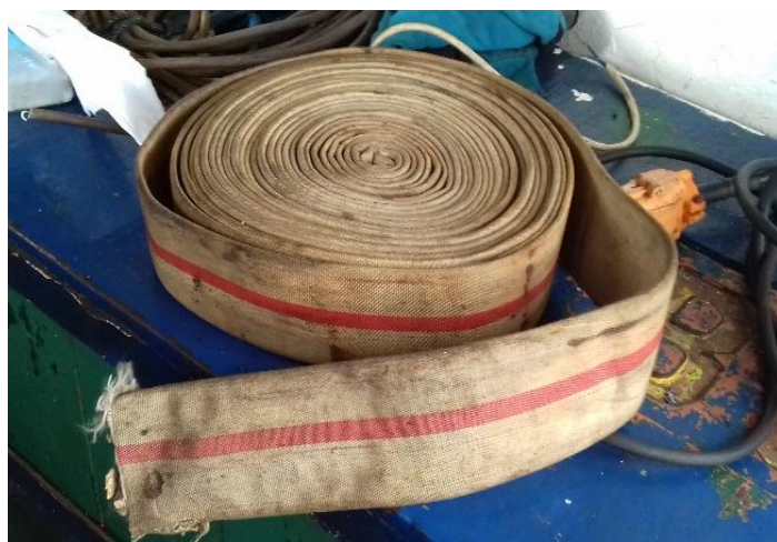
Gambar 8: Slang (hose) hidran tanpa kopleng
