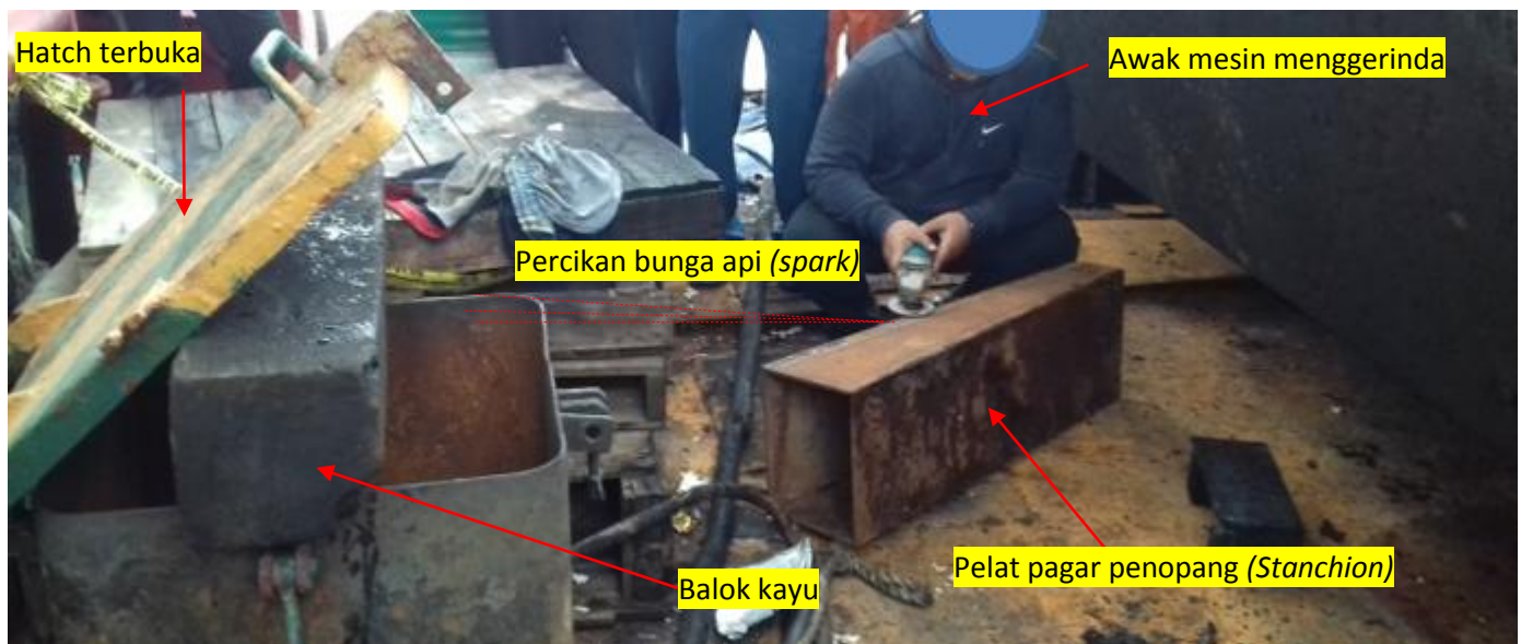
Gambar 1: Awak kapal mesin sementara melakukan gerinda (rekonstruksi kejadian)
