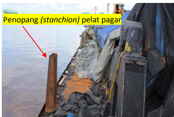
Gambar 6: Penggantian pagar kapal Lintas Bahari-8 yang telah hilang dan keropos
