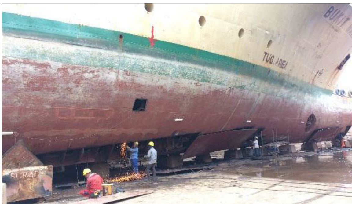
Gambar I-9: Pekerjaan replating pada lambung kapal yang rusak (kanan)
