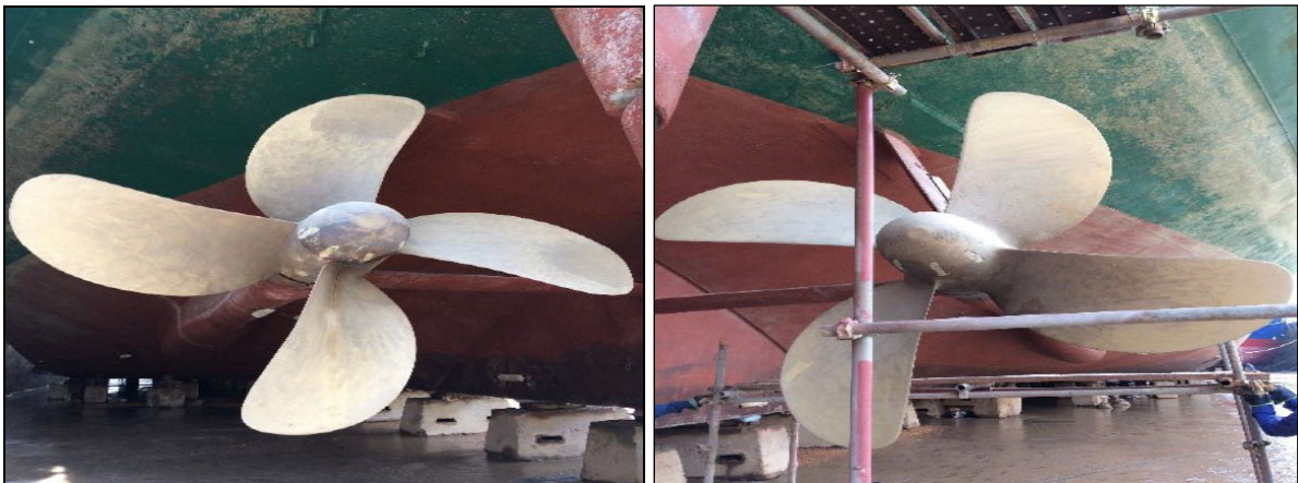
Gambar I-11: Kedua baling-baling dalam kondisi baik
