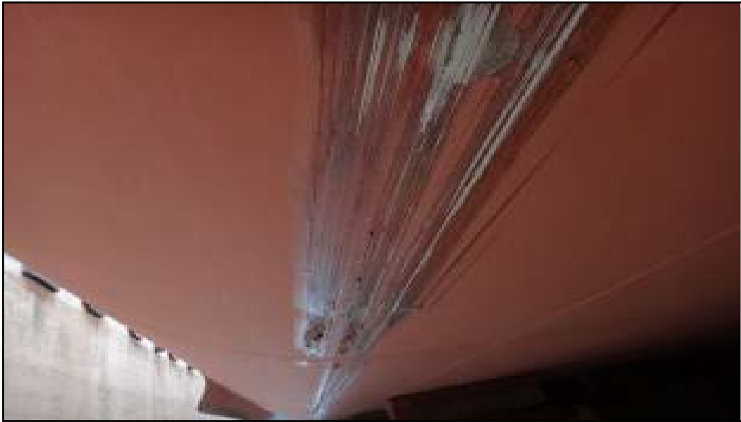
Gambar I-8: Kerusakan cat Anti Fouling pada pelat dasar kapal (kiri)
