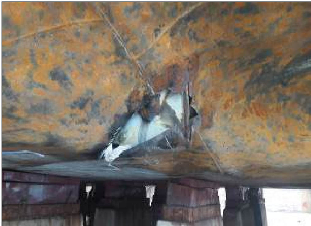
Gambar I-7: terdapat robek pada plat bottom
