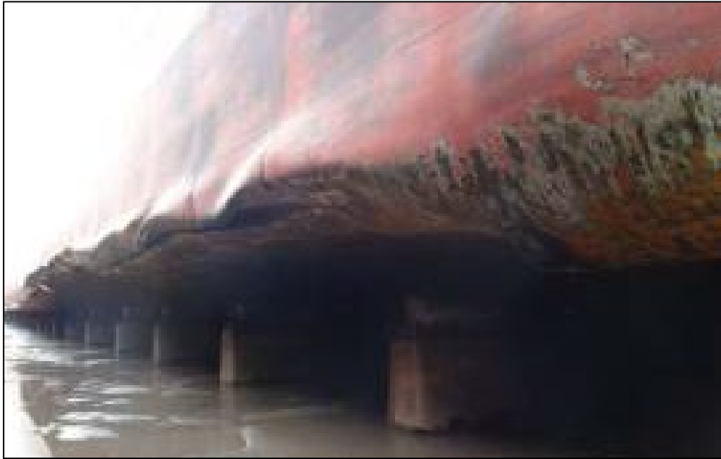
Gambar I-6: Kerusakan konstruksi pelat dasar dan samping daerah WBT 1, WBT No.2, cargo Hold No.2 dan Cargo Hold No.3 (kiri) Centaurus Dream
