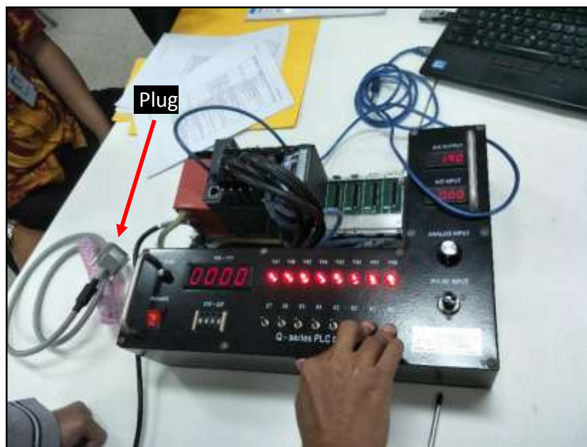
Gambar I-9: Pengujian power supply Q61P dengan beban dan keluaran.
