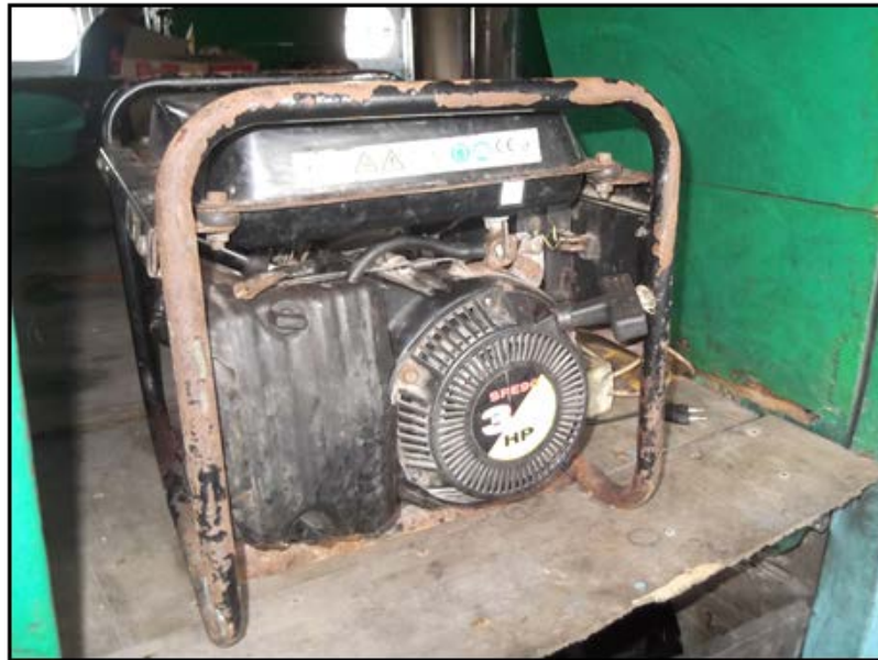
Gambar I-4: Pompa portabel digunakan sebagai pompa bilga (Gambar diperoleh dari Kantor UPP Kelas I Baubau)
