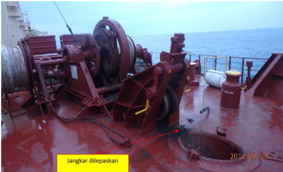
Gambar I-14: Jangkar kiri Maestro Diamond yang dilepaskan.
