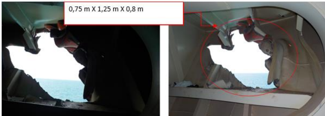
Gambar I-16: Kerusakan pada bagian haluan Angel No.1.
