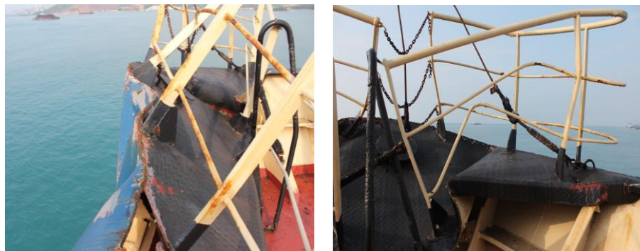
Gambar I-12: Lambung depan sebelah kanan dan railing rusak
