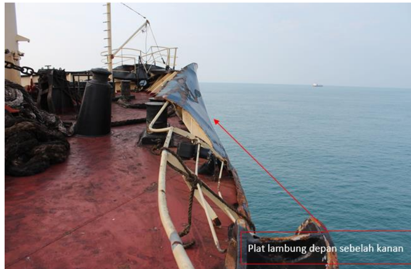
Gambar I-11: Lambung sebelah kanan setelah senggolan
