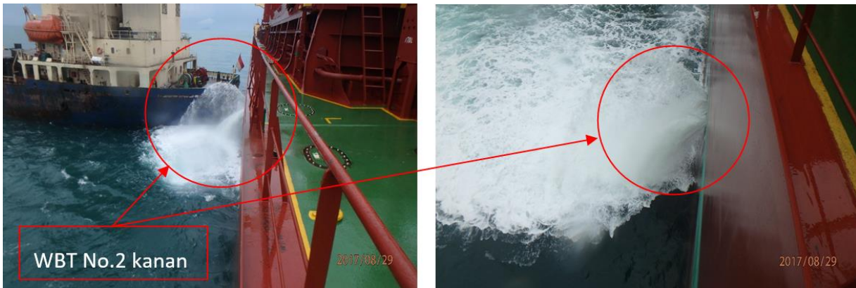
Gambar I-5: Lambung Maestro Diamond bocor saat senggolan.
