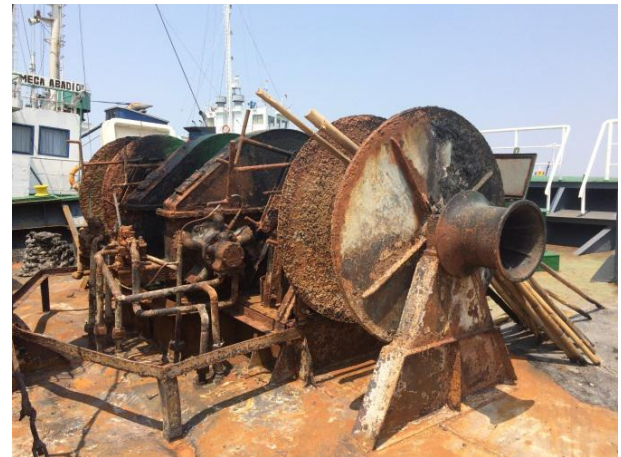
Gambar 7: Kerusakan mesin jangkar kapal
