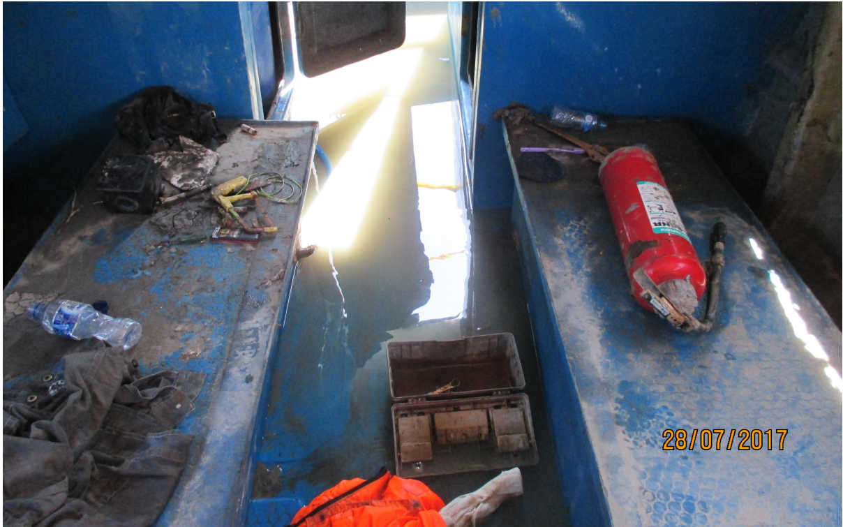
Gambar I- 9: Tangki bahan bakar kiri dan kanan yang digunakan juga sebagai tempat duduk penumpang
