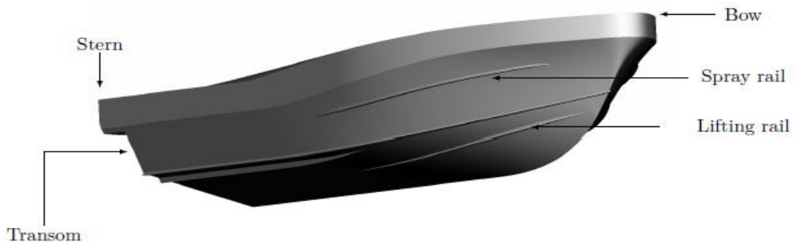
Gambar 0- 4: Karakteristik lambung planing
