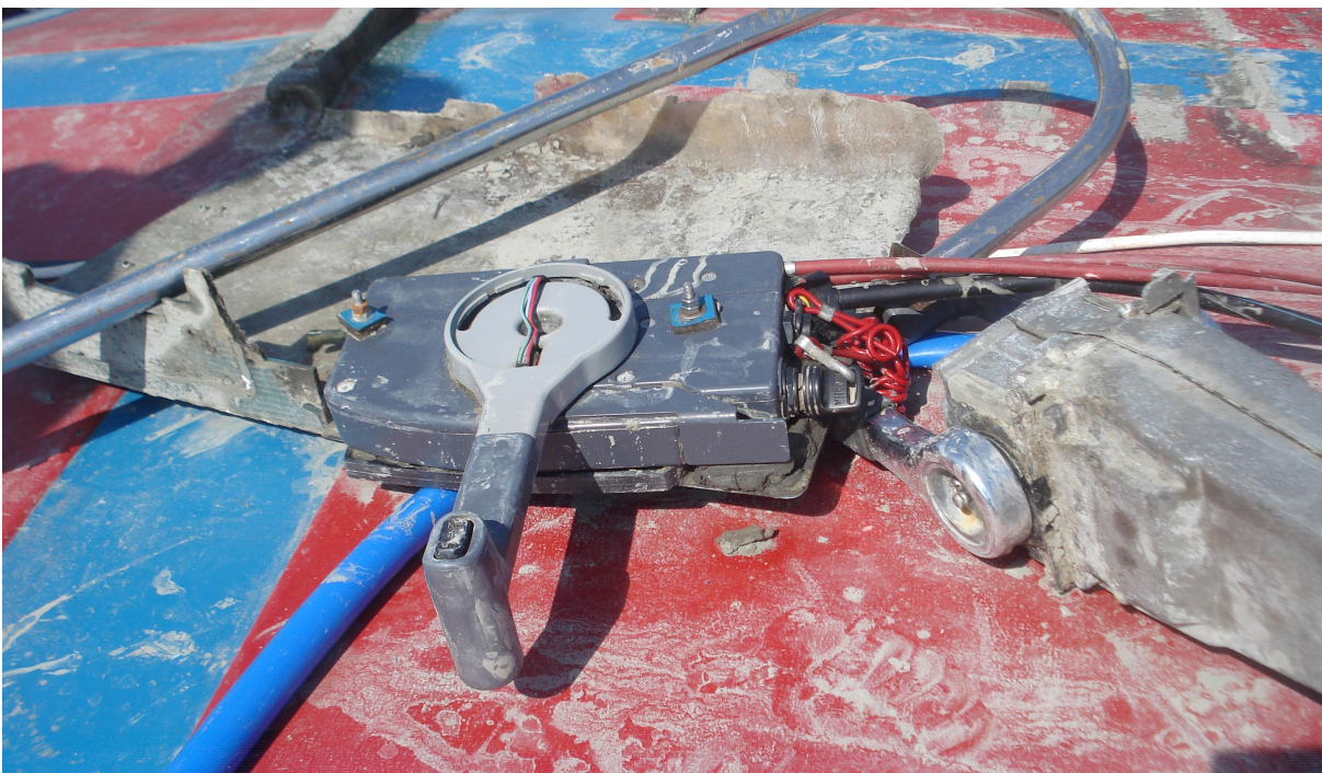
Gambar I- 12: Sistem kendali kecepatan speed boat yang rusak
