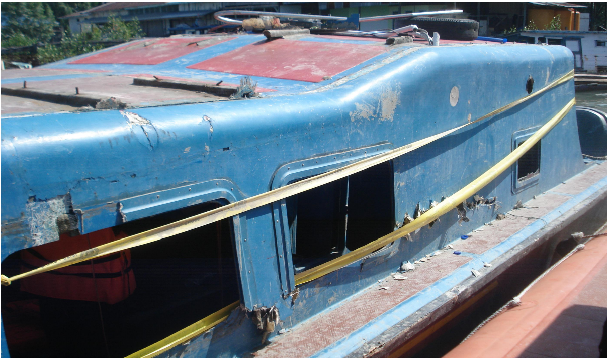
Gambar I- 11: Ruang kendali kemudi rusak dan hilang
