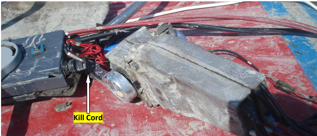
Gambar I-6: Peralatan kill cord pada Rejeki Baru Kharisma
