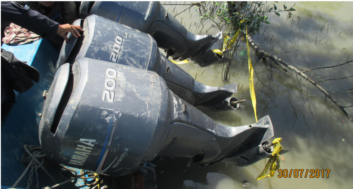
Gambar I-5: Mesin luar sebagai mesin penggerak utama Rejeki Baru Kharisma
