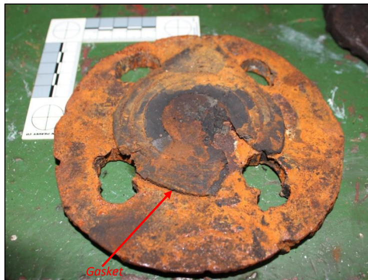
Gambar I-7: Gasket blind flange yang rusak
