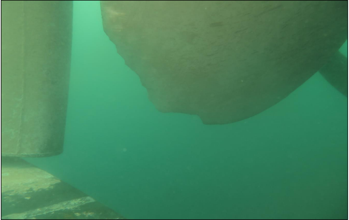
Gambar I-2: Baling-baling Kutai Raya Dua bengkok dan rusak
