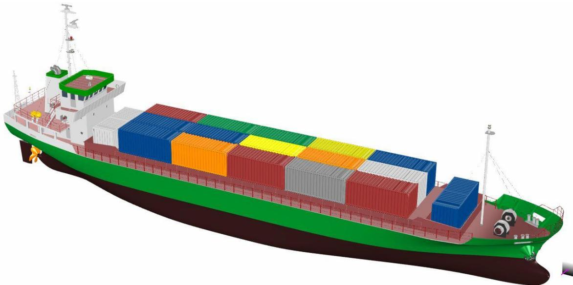
**Gambar I-5: Peletakan Muatan di Atas Geladak**
