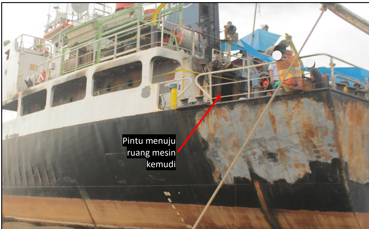
Gambar II-2: Pintu ruang mesin kemudi yang terbuka
