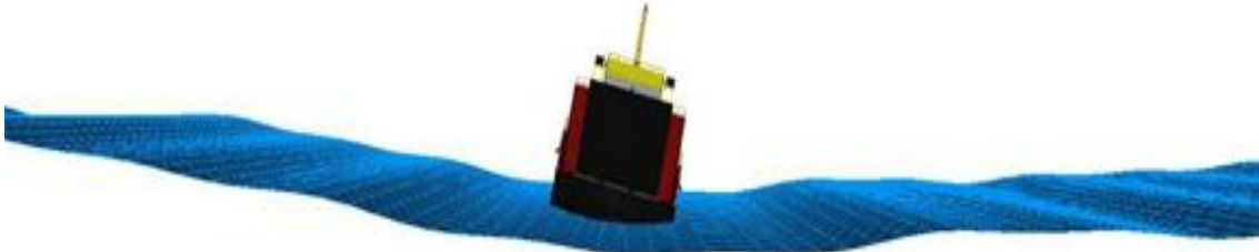
Gambar 8: Kapal mulai mengalami rolling ke kiri karena menerima gelombang dari kanan lambung kapal dan muatan tergeser ke kiri
