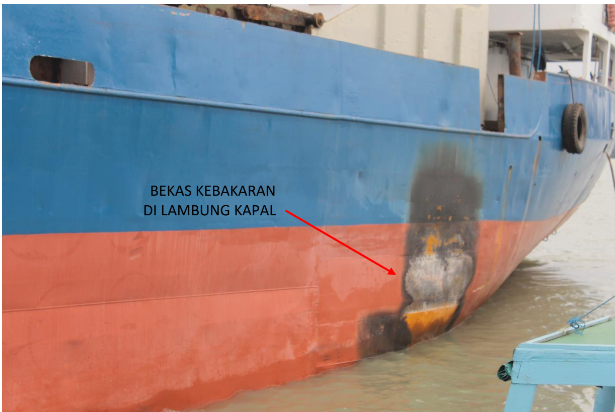
Gambar 6 : Kondisi lambung kiri akibat kebakaran
