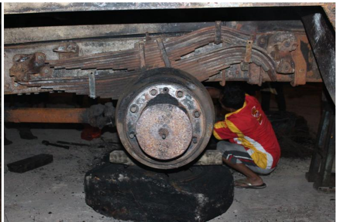
Gambar 5: Kondisi kebakaran pada truk boks sisi kanan (kiri) dan Kondisi roda dan pegas daun kiri belakang truk boks (kanan)
