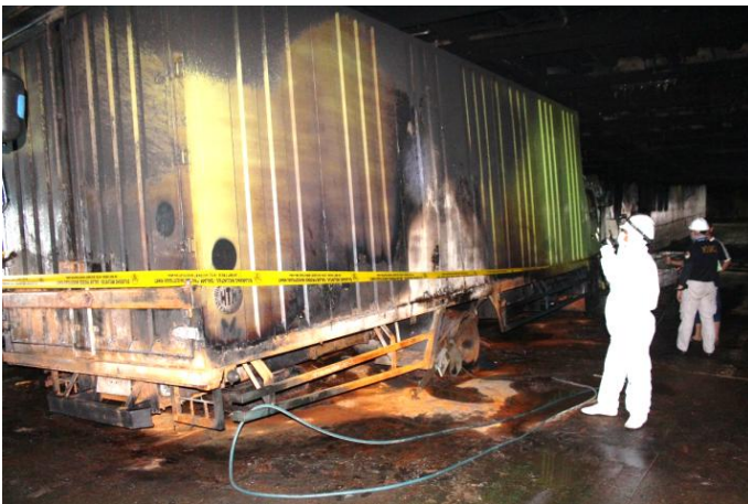
Gambar 5: Kondisi kebakaran pada truk boks sisi kanan (kiri) dan Kondisi roda dan pegas daun kiri belakang truk boks (kanan)
