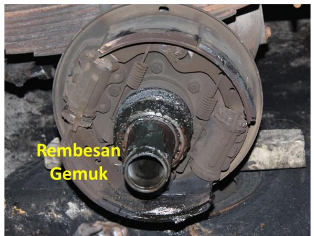
Gambar 7: Kondisi ban belakang truk boks dan bagian dalam sistem pengereman yang terdapat rembesan gemuk ( grease )
