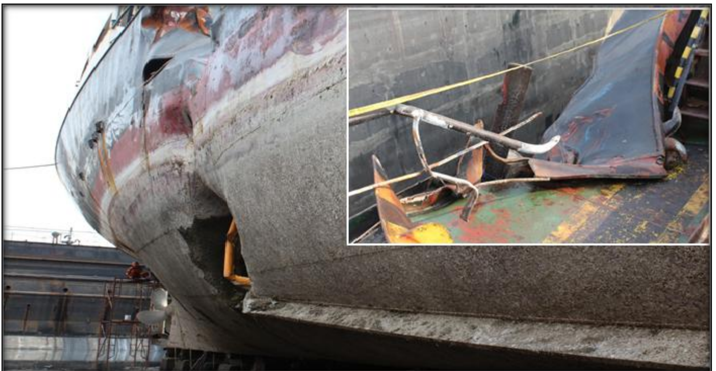
Gambar 2: Kondisi lambung Elisabet tangki muat No. 4 kanan saat kapal di galangan
