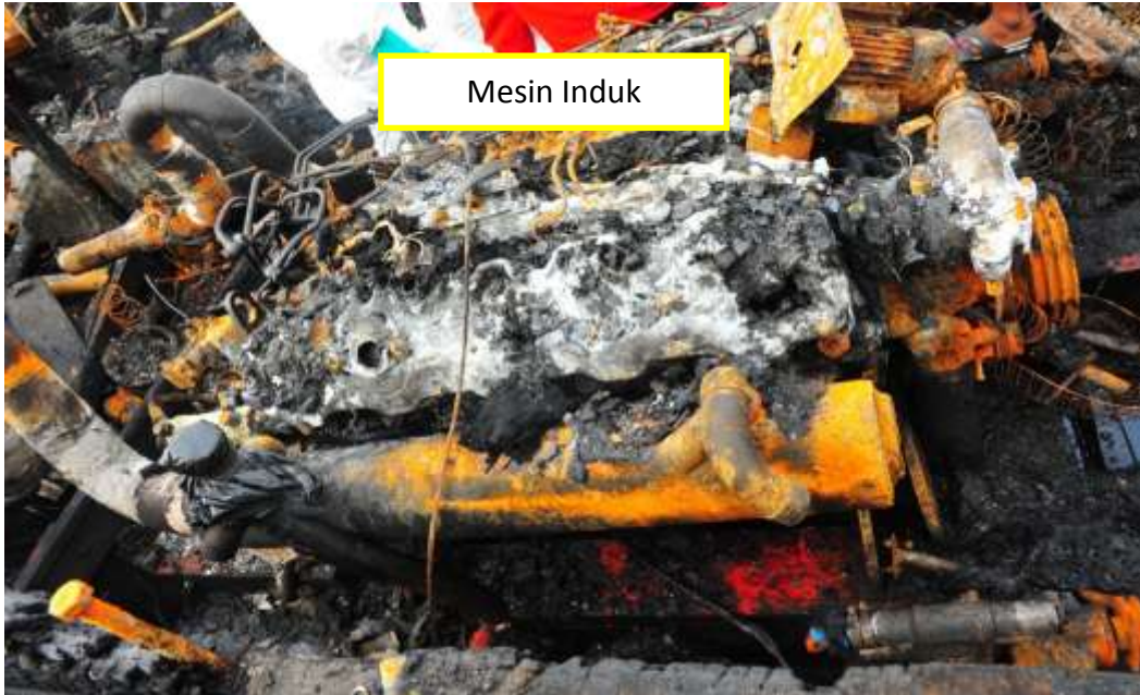
Gambar I-17: Kondisi mesin induk KM. Zahro Express setelah terbakar
