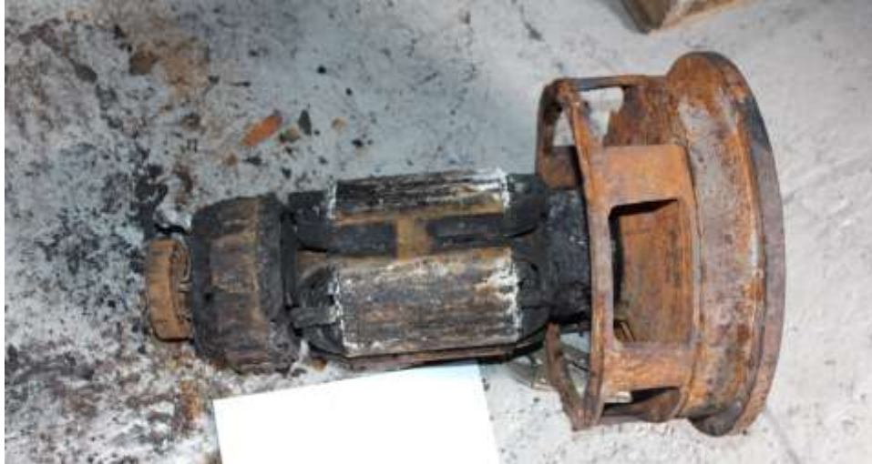
Gambar I-35: Pemeriksaan Rotor Generator Listrik
