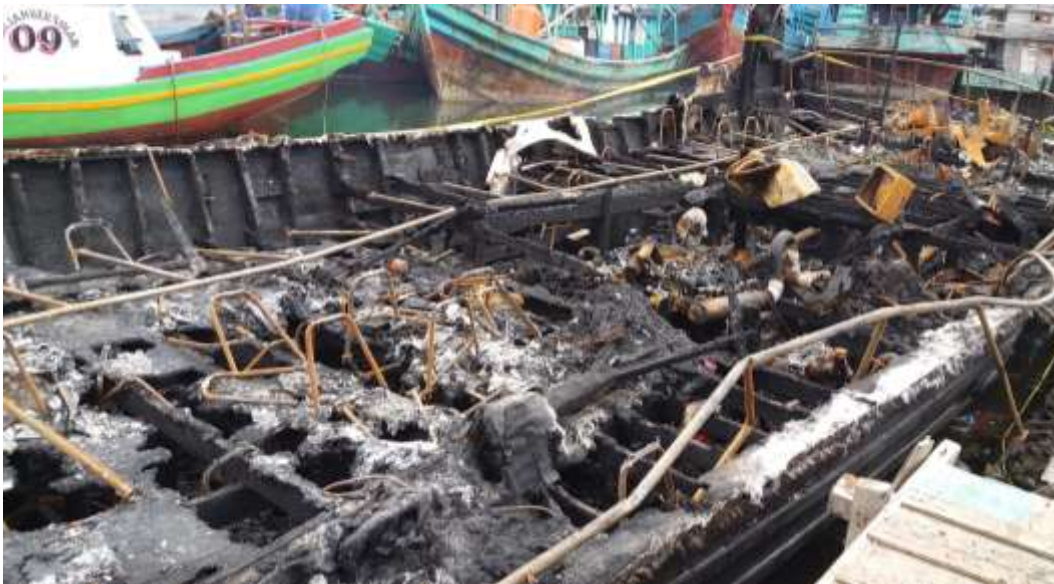
Gambar I-25: Kondisi dek KM. Zahro Express setelah terbakar
