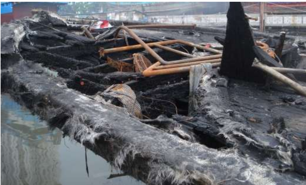
Gambar I-14: Sisa kebakaran bahan FRP yang digunakan sebagai pelapis geladak
