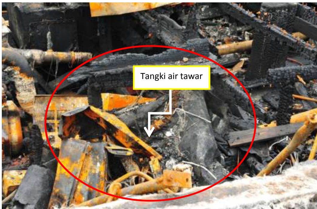
Gambar I-24: Kondisi tangki air tawar hangus terbakar
