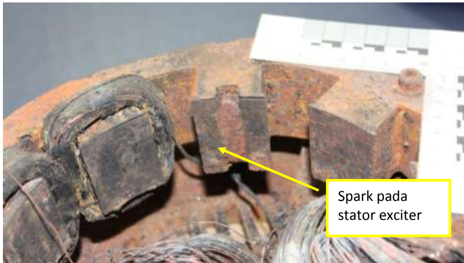
Gambar I-37: Electric sparks pada stator exciter
