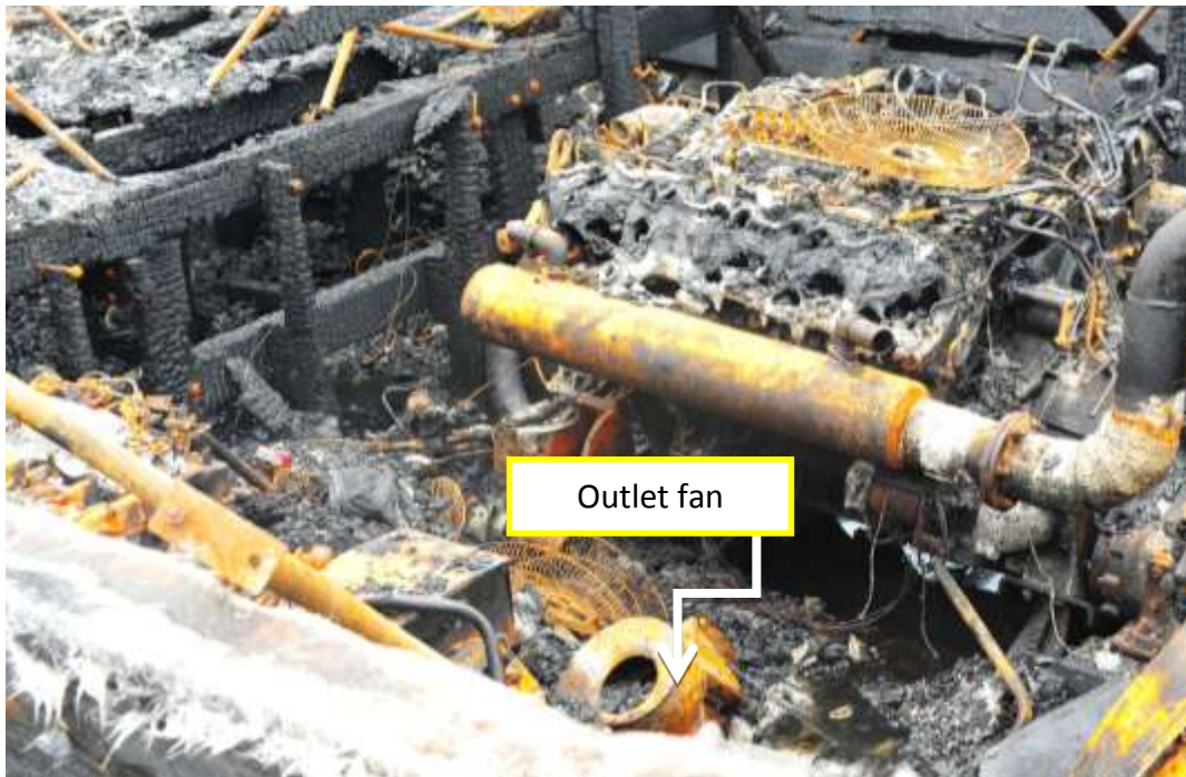
Gambar I-20: Ventilator udara keluar (outlet fan) hangus terbakar
