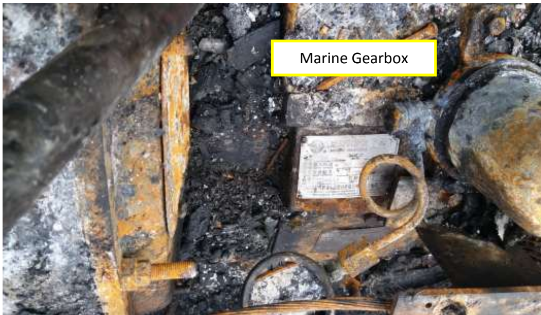
Gambar I-18: Kondisi gearbox KM. Zahro Express setelah kebakaran
