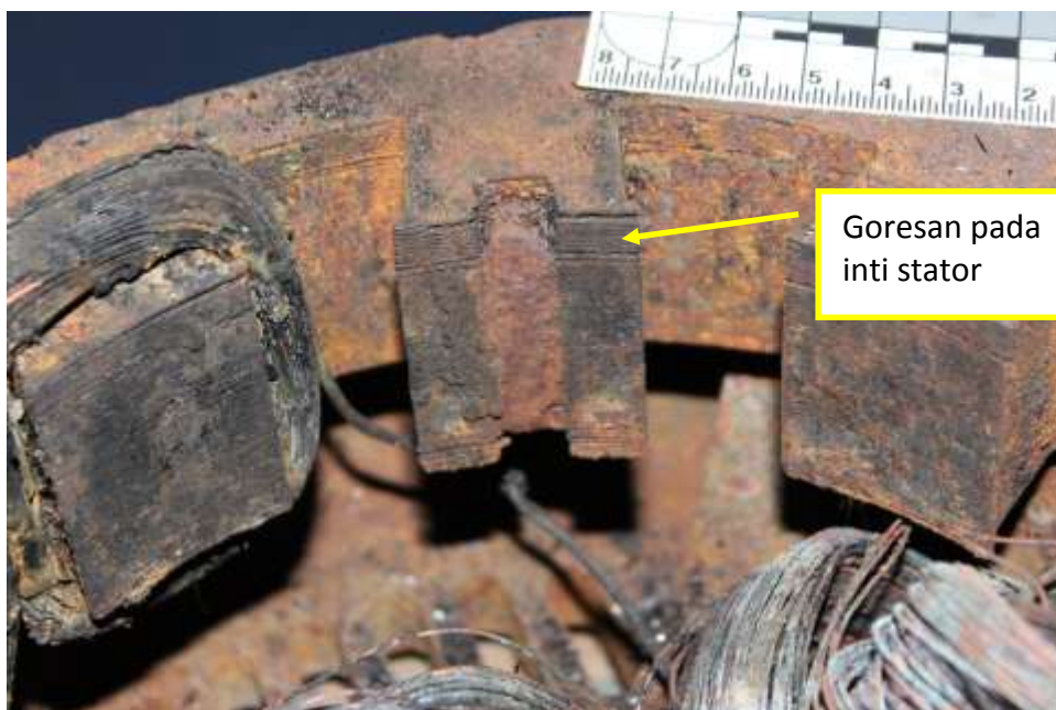
Gambar I-36: Goresan pada stator exciter
