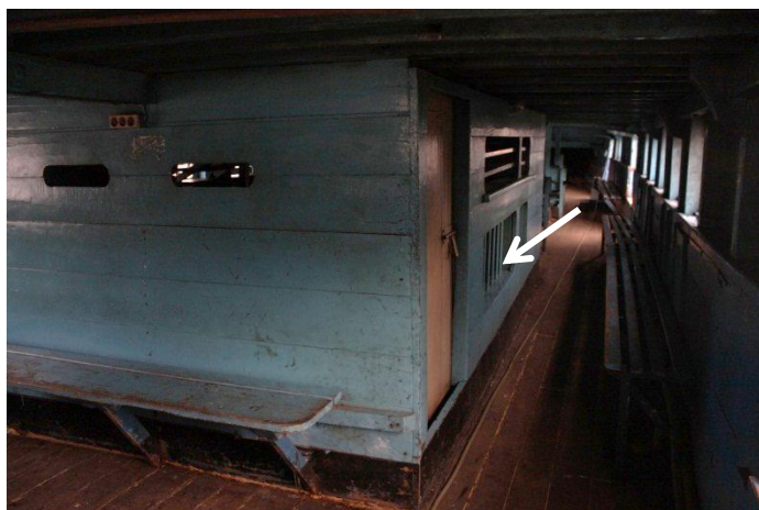
Gambar 3: Selubung kamar mesin pada kapal yang serupa dengan Karamando . Panah putih menunjukkan ventilasi kamar mesin pada posisi yang rendah dan dekat dengan geladak utama.
