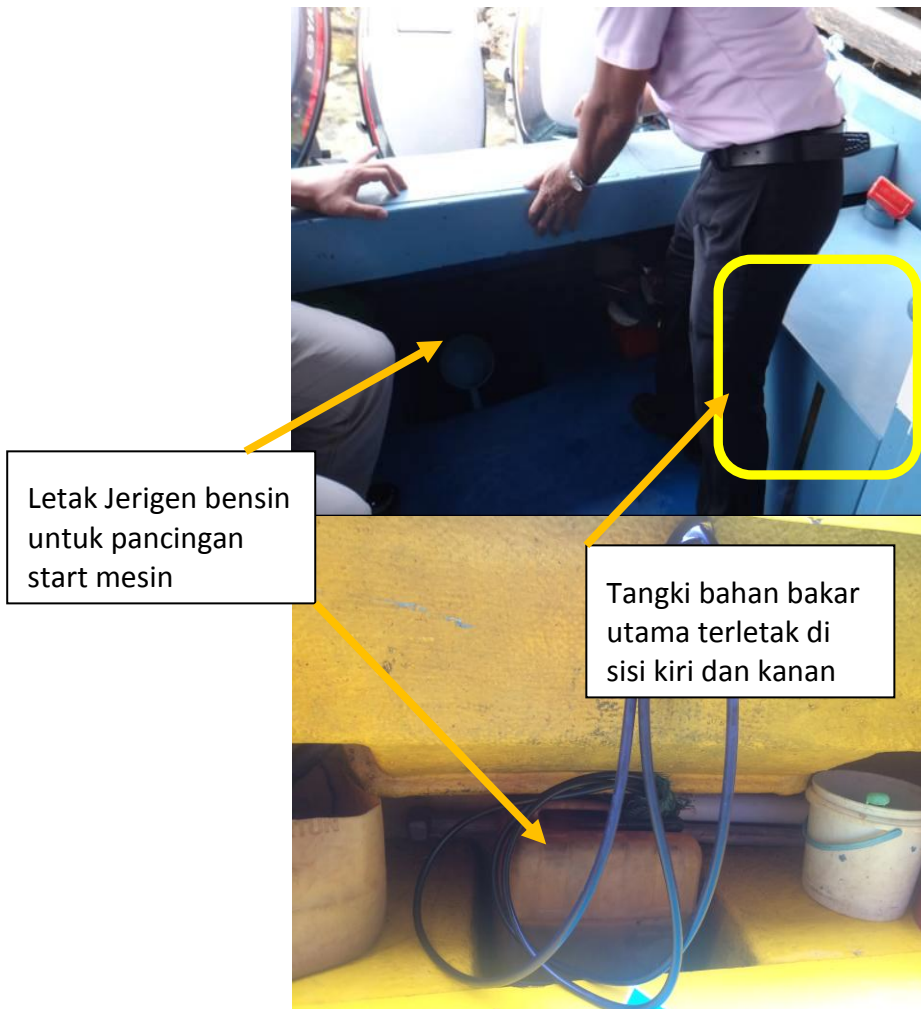
Gambar II-4: Letak jerigen bensin untuk pancingan pada waktu start mesin
