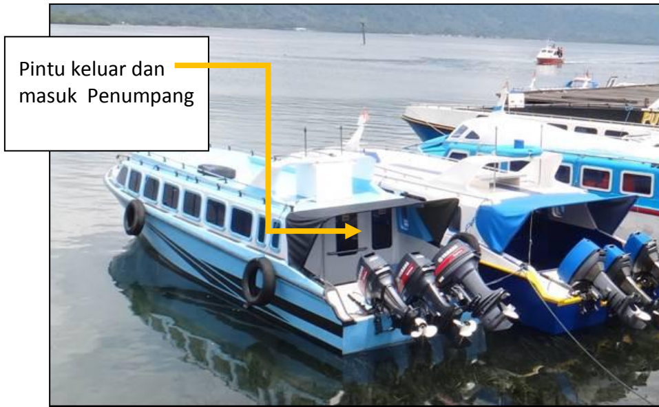
Gambar II-7: Pintu keluar dari belakang pada speed boat yang sejenis
