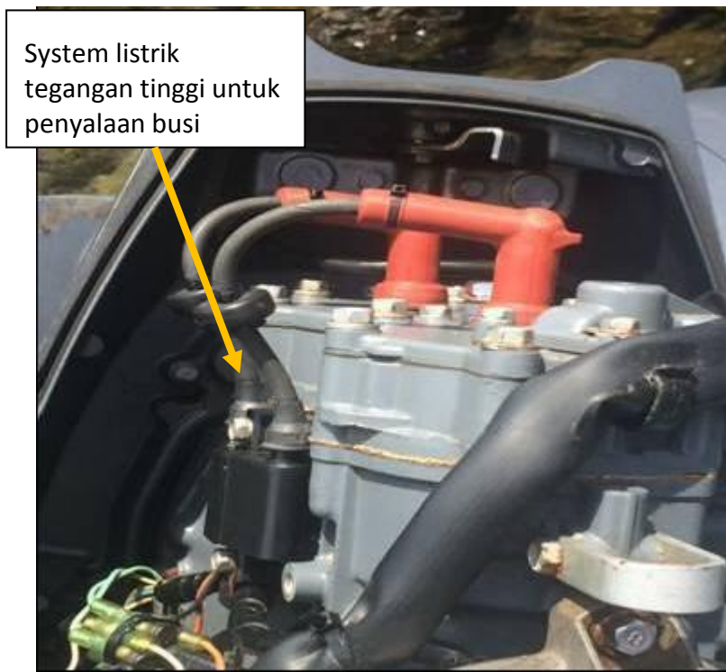
Gambar III-2: System listrik untuk penyalaan busi
