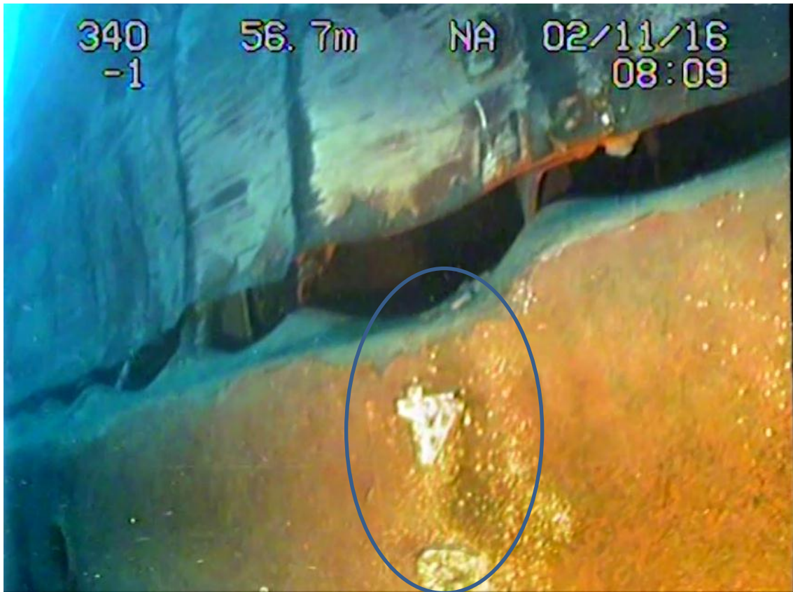
Gambar I-9: profil kerusakan lambung kanan kapal hasil pemeriksaan bawah air di sekitar midship. Lingkaran biru merupakan marka garis air di tengah kapal
