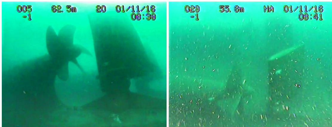
Gambar I-6: Baling-baling dan kemudi KM. Dharma Kencana VIII yang ditemukan pada saat survey bawah air
