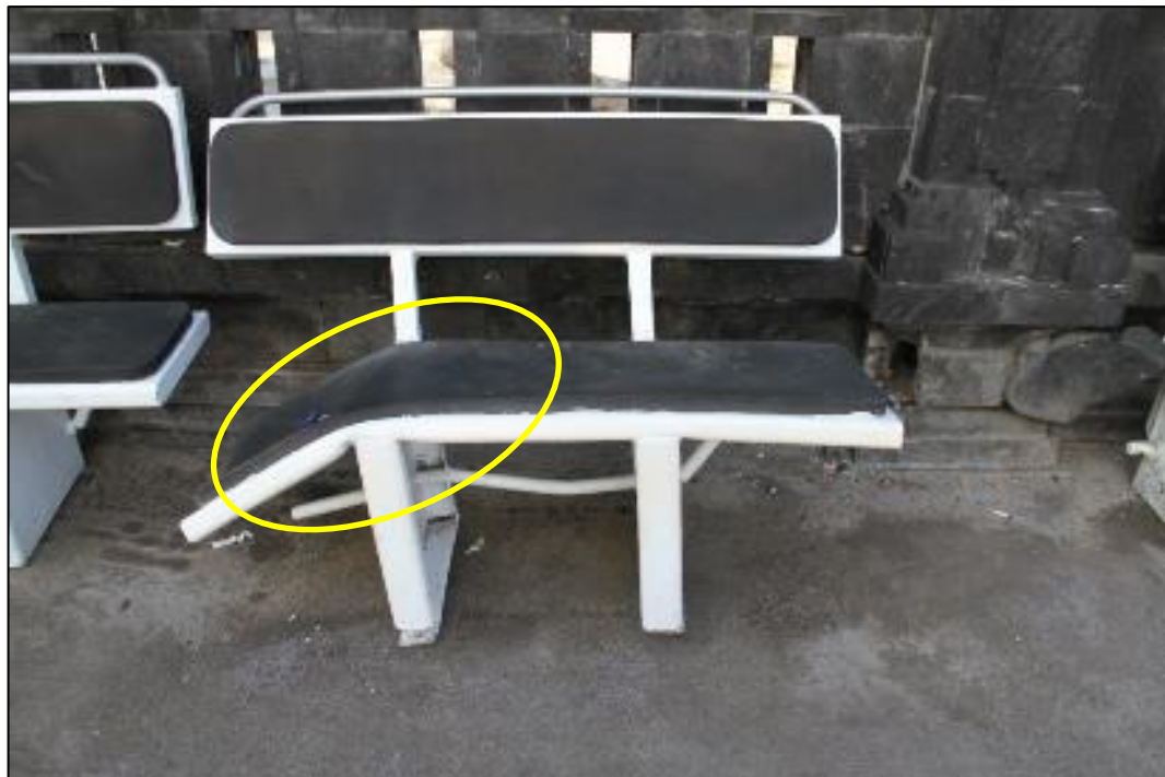
Gambar I-19: Kondisi salah satu kursi yang terdeformasi.
