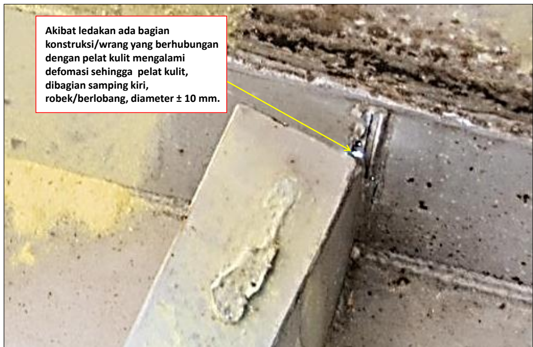
Gambar I-23: Lubang pada pelat kulit lambung kiri-belakang.
