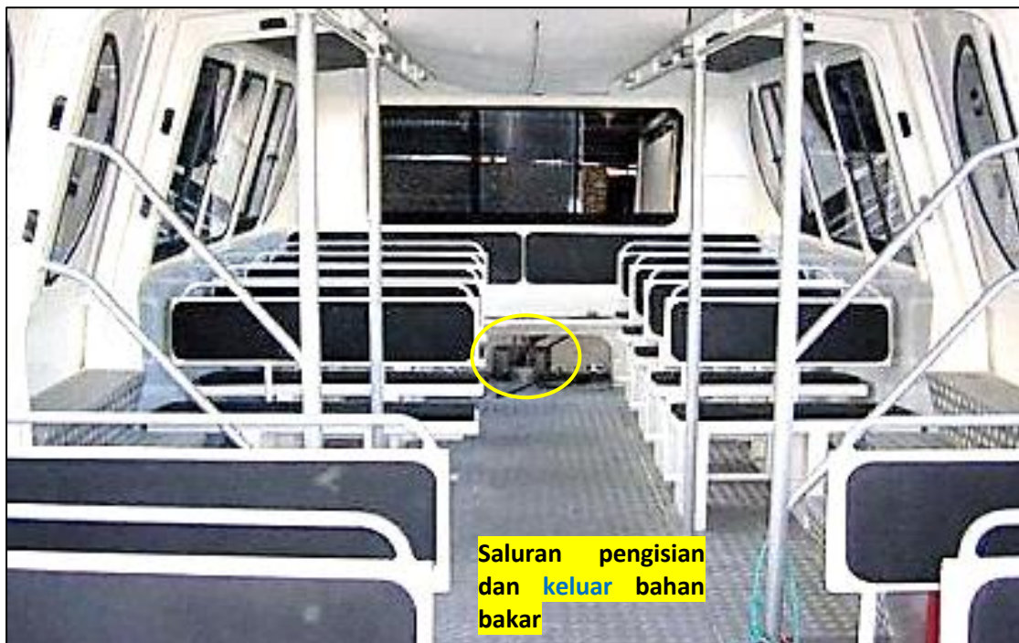
Gambar I-36: Saluran pengisian dan keluar tangki bahan bakar yang terlihat dari kabin penumpang.
