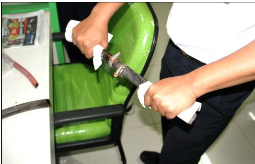
Gambar I-40: Investigator KNKT sedang mencoba untuk melepaskan sambungan slang udara dengan cara diputar dan ditarik ke arah berlawanan.
