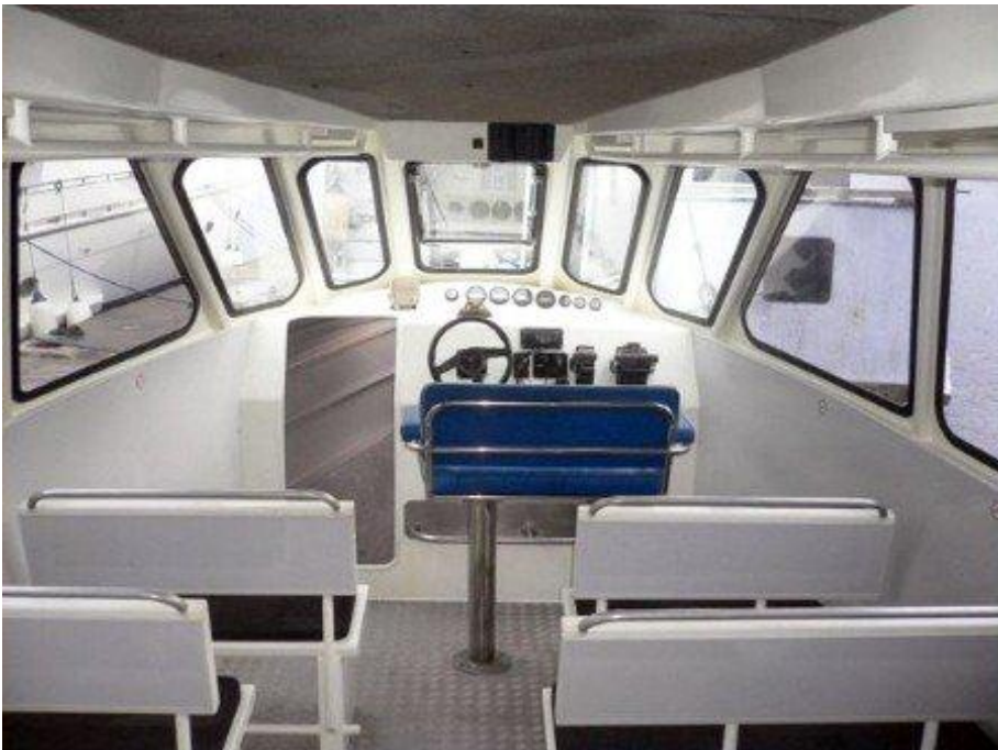
Gambar I-2: Interior Gili Cat II (tampak haluan) berikut posisi tempat duduk dan kemudi
