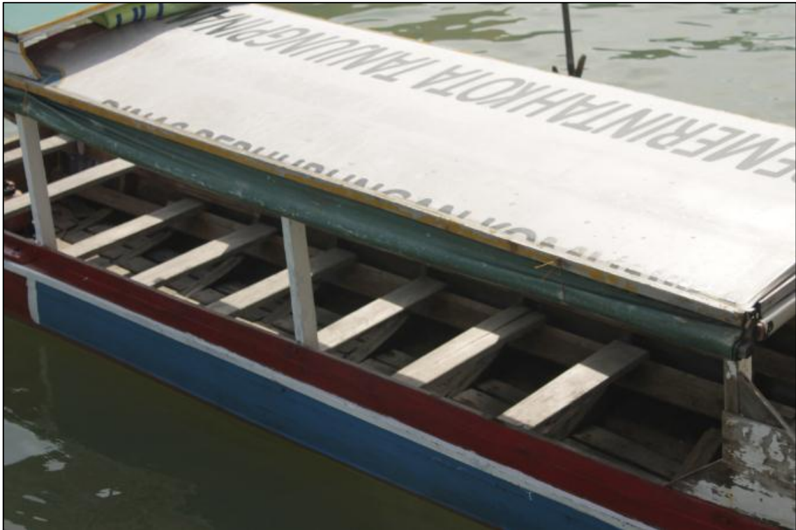
Gambar I-4: Posisi papan duduk penumpang di kapal pancung
