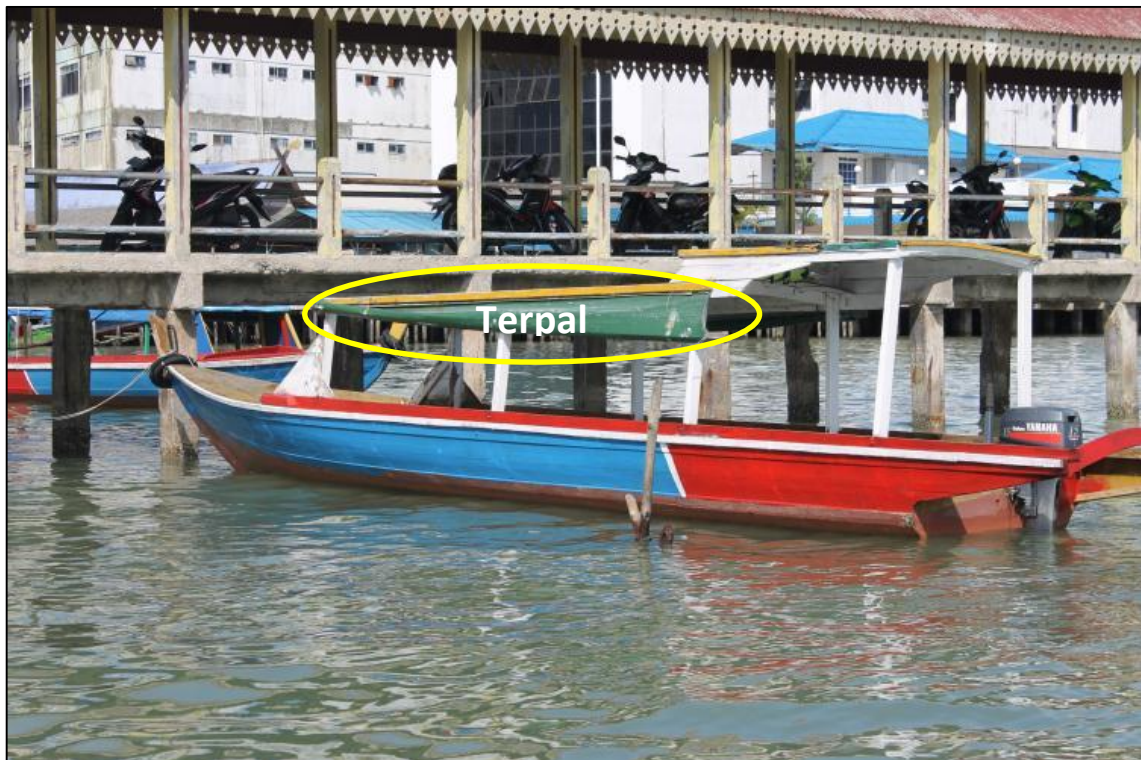
Gambar I-5: Kapal pancung serupa dengan kapal yang terlibat kecelakaan. Kanopi terpasang pada bagian tengah kapal dan terpal di sisi kanan dan kiri kapal untuk menahan panas atau air.
