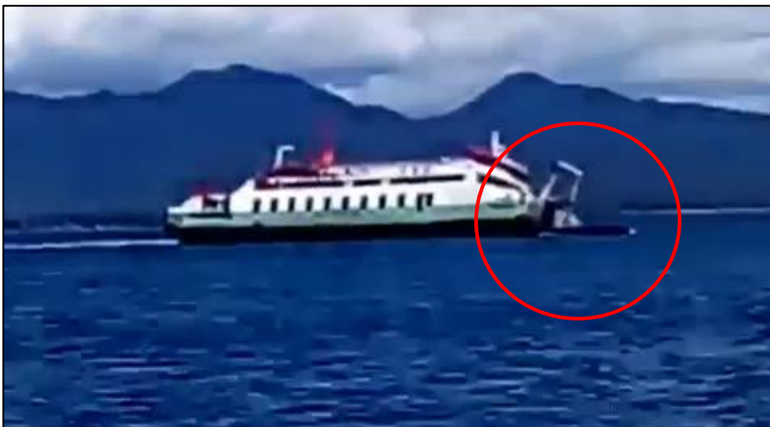
Gambar I-23: Pintu Rampa haluan yang sudah terbuka
