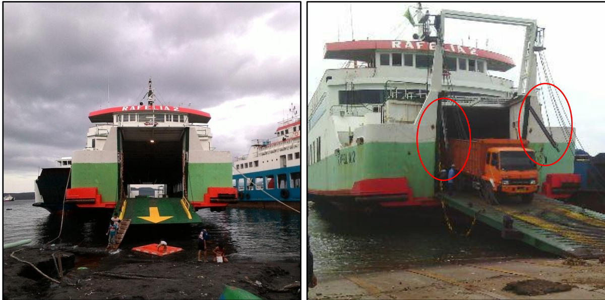
Gambar I-11: perbedaan rampa yang lama (kiri) dengan rampa yang baru (kanan). Stopper (lingkaran merah) dan struktur penahan pintu rampa yang baru (lingkaran biru).
