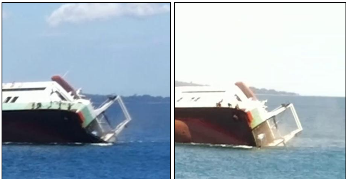
Gambar II-5: Pintu Rampa haluan yang masih terpasang (kiri) dan ketika terlepas (kanan)
