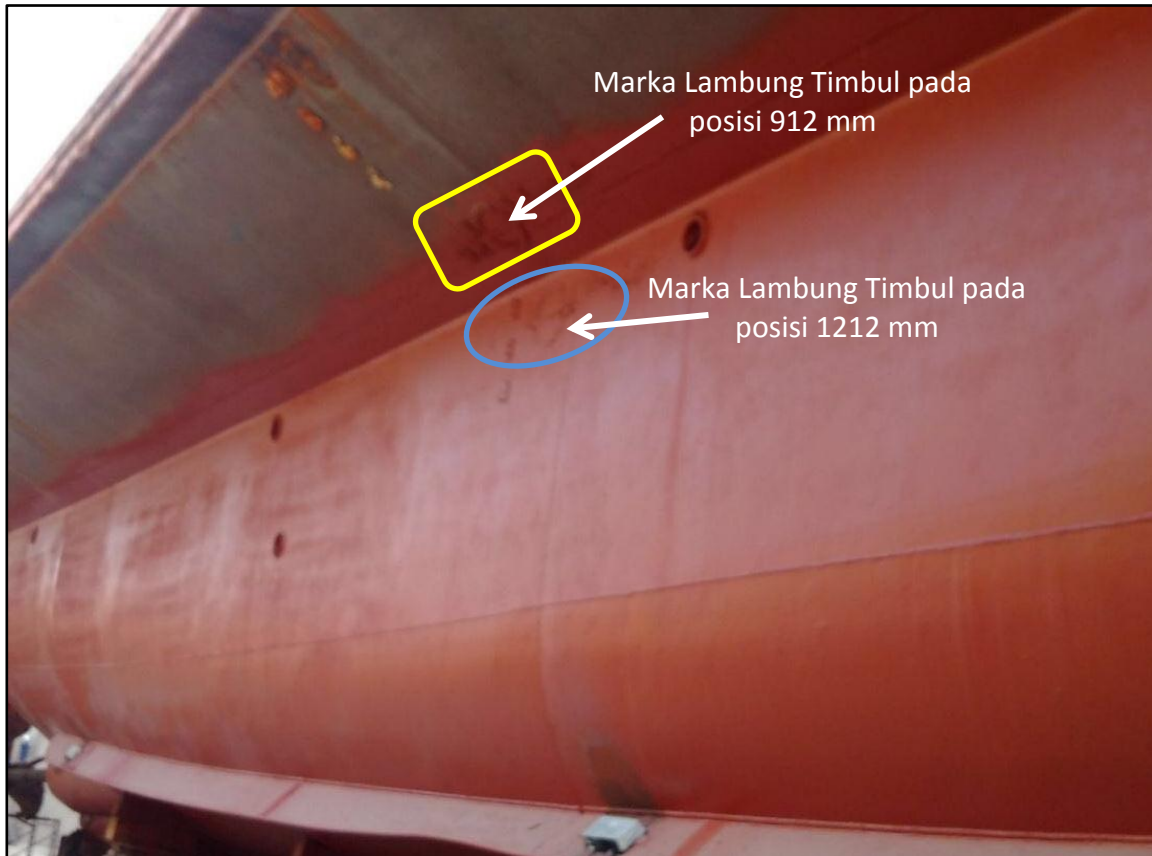
Gambar I-7: Posisi lambung timbul yang lama (lingkaran biru) dan posisi tanda lambung timbul yang sudah dirubah (kotak kuning)
