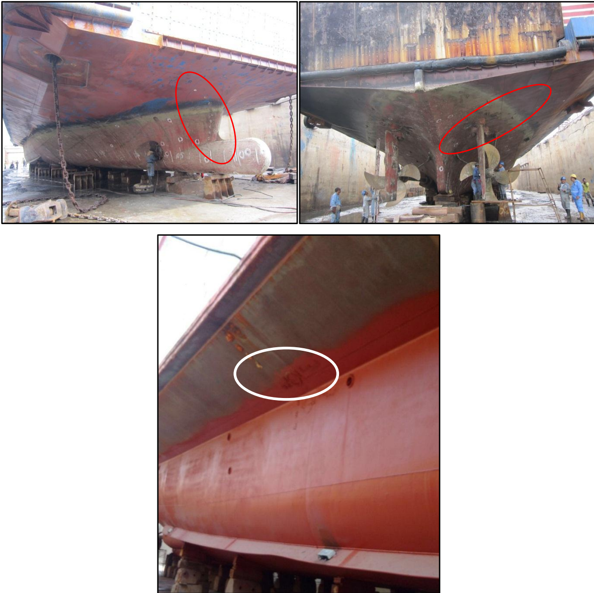
Gambar II-9: Posisi tanda lambung timbul (bawah-lingkaran putih), sarat kapal pada bagian haluan (atas kiri) dan buritan (kanan)
