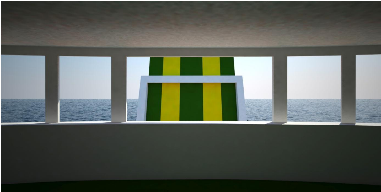
Gambar II-12: Rekonstruksi operasional pintu rampa. perspektif dari anjungan yang menunjukkan tertutupnya pandangan akibat tertutup pintu rampa
