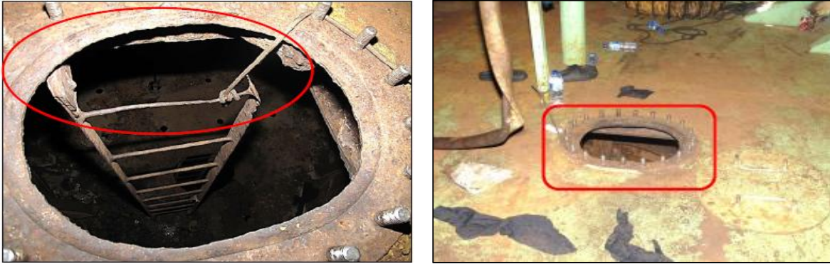
Gambar I-3: Akses masuk ke dalam tangki air tawar haluan melalui sebuah manhole di geladak atas
