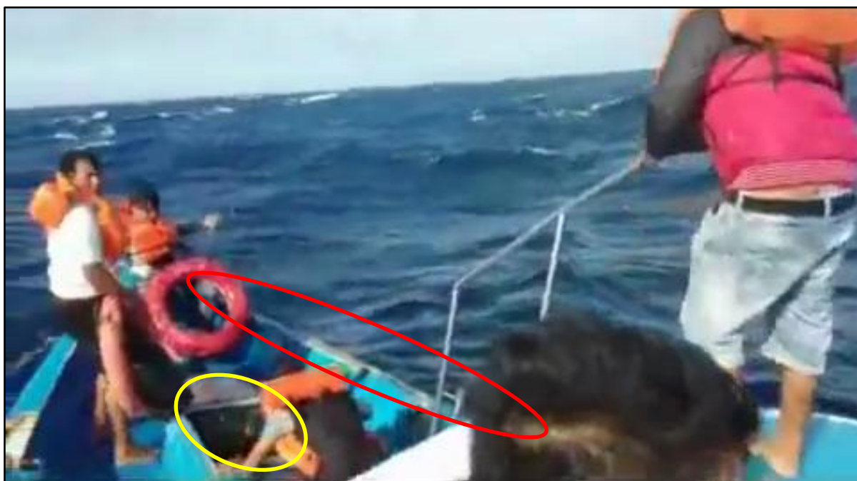
Gambar I-11: Kerusakan pada kubu-kubu haluan sisi kanan (lingkaran merah) dan terbukanya pintu akses orang ke ceruk haluan (lingkaran kuning)
