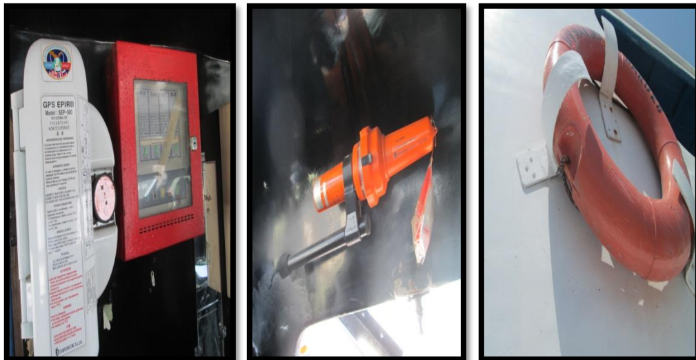
Gambar I-3: EPIRB, SART dan Pelampung di MV. Marina Baru 2B
