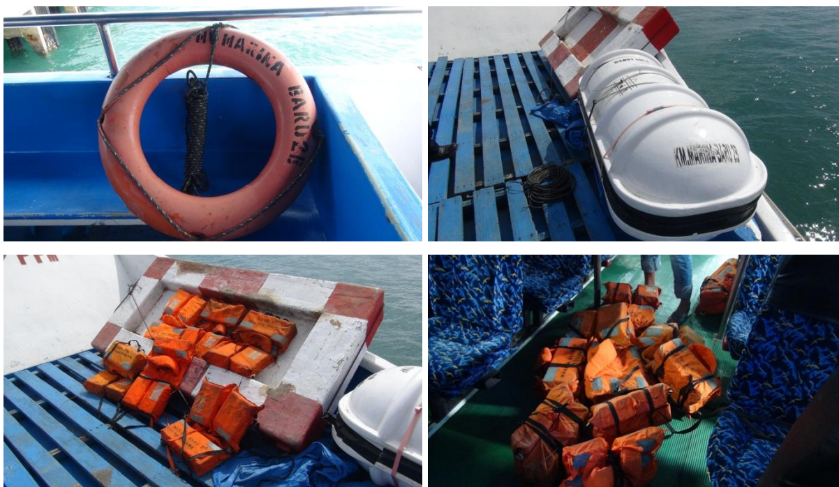
Gambar II-11: Kondisi peralatan keselamatan di MV. Marina Baru 2B
