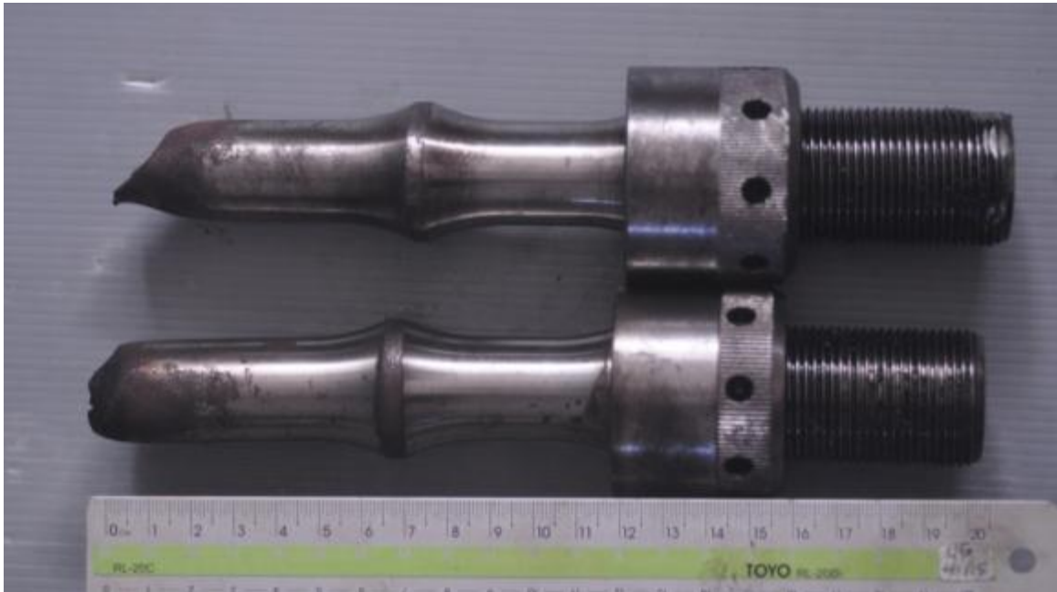
Gambar I-6: Patahan dg reduksi penampang yg besar (atas) Patahan dg reduksi penampang yg kecil (bawah)
