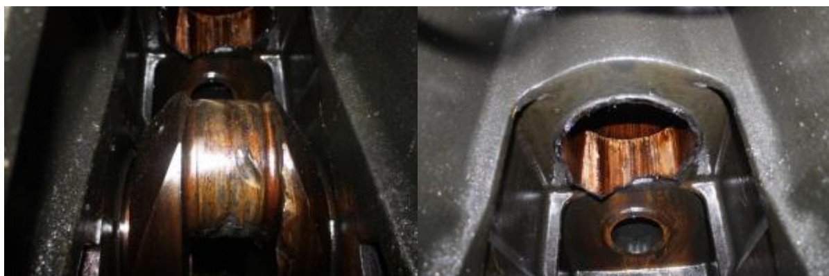
Gambar I-12: kerusakan berupa lecetan dan guratan pada crankshaft (kiri) dan kerusakan pada ruang pembakaran (kanan)
