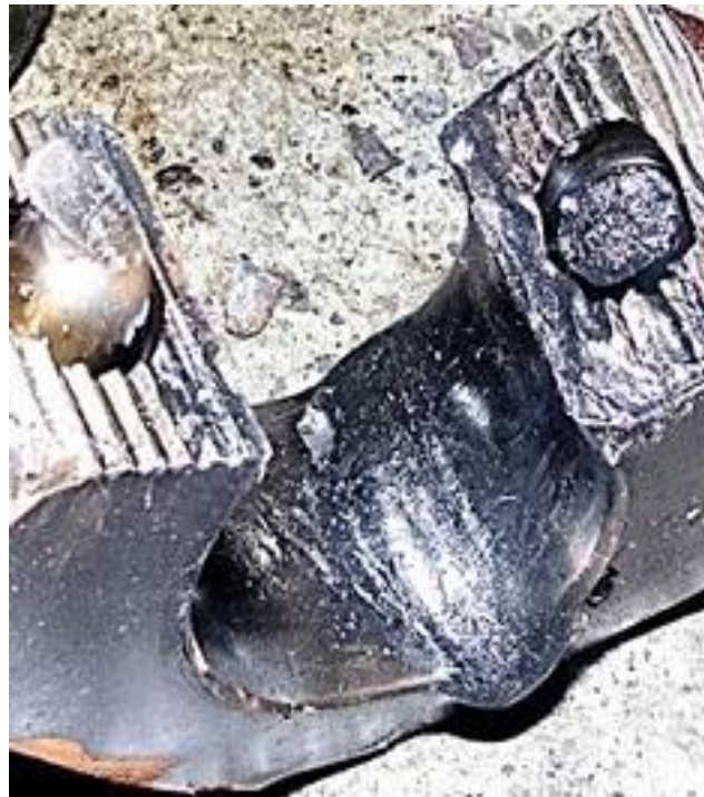
Gambar I-10: Bagian bawah stang piston menunjukkan adanya bekas goresan dan benturan
