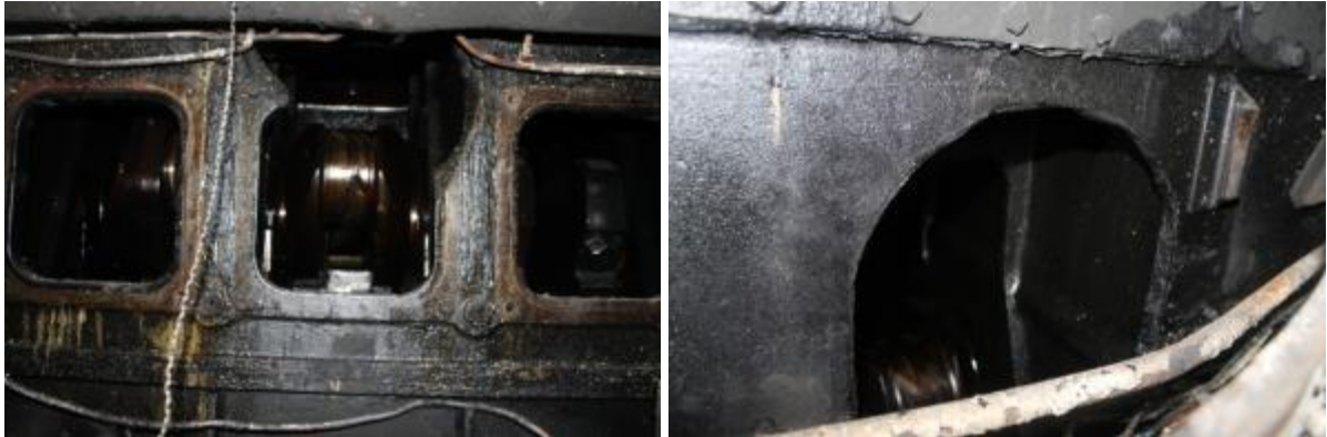
Gambar I-4: kerusakan dinding block mesin pada cylinder no 3. Mesin AE No.2.
