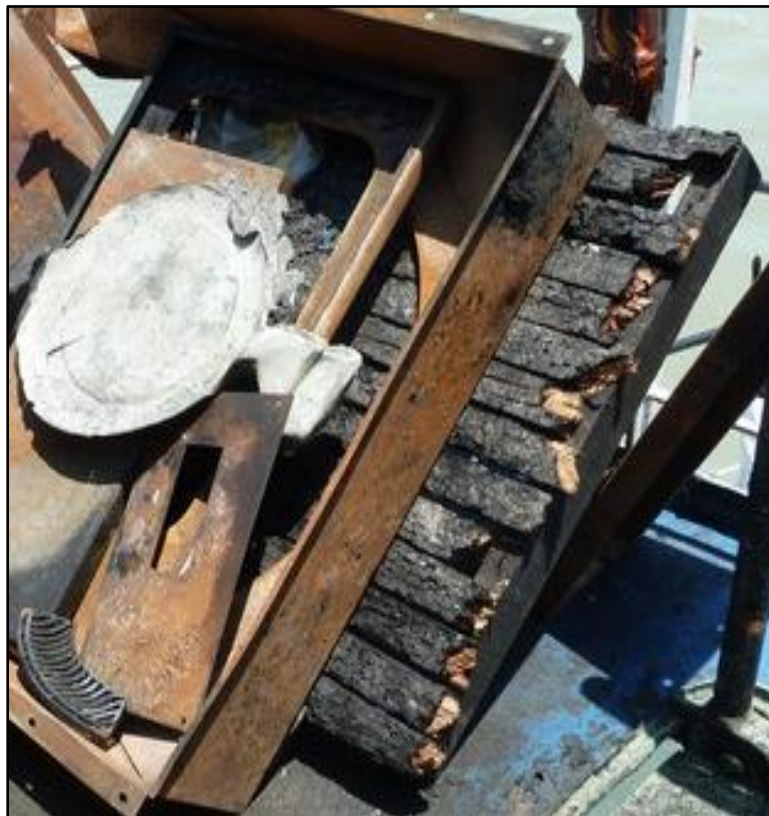
Gambar II-4: Sisa kayu alas geladak sekoci di sekitar mesin genset
