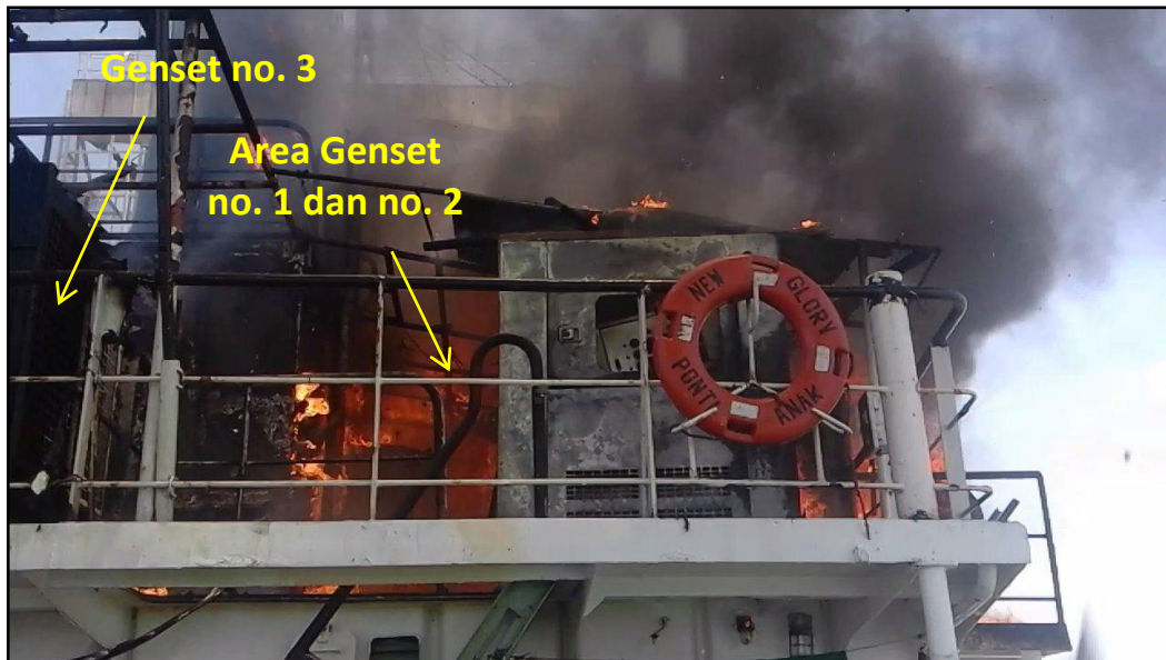
Gambar I-3. Kondisi kebakaran di area genset
