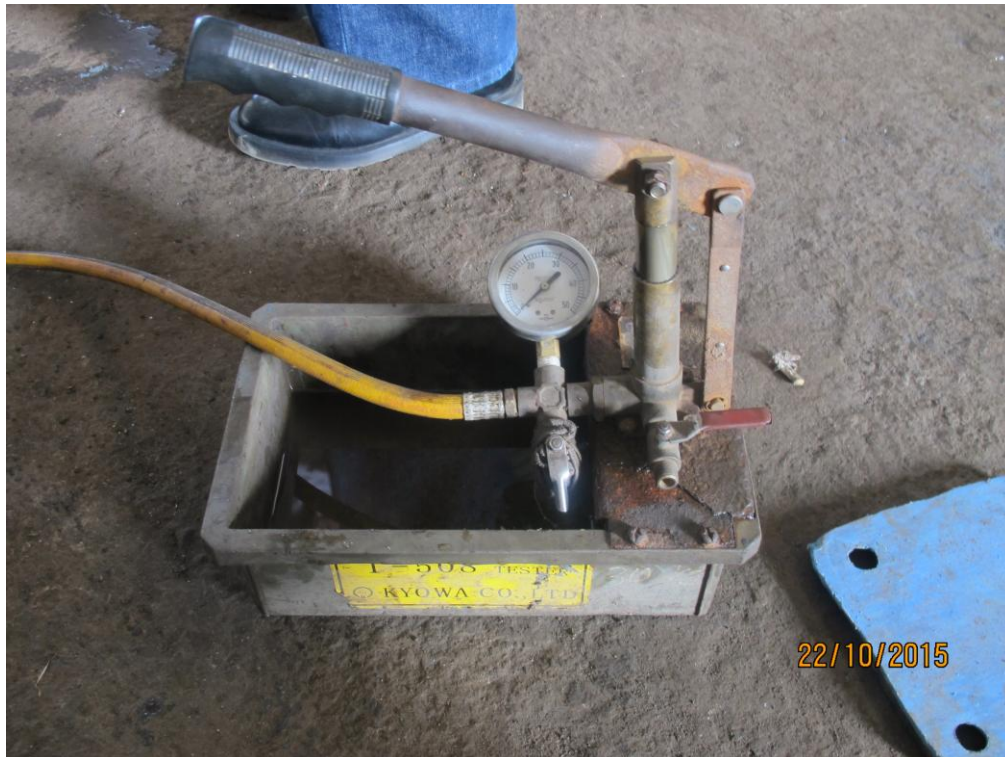
Gambar 1.5: peralatan uji tekan hidrolis dengan medium air untuk pressure test
