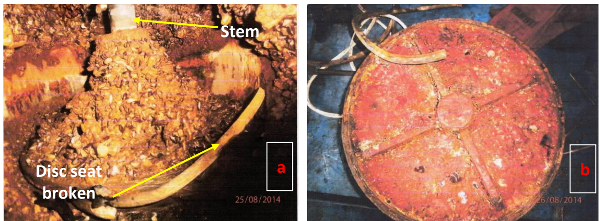
Gambar 1.3: a) kondisi di dalam valve sebelum dibuka dan dilakukan perbaikan; b) kondisi valve disc setelah dibuka dan sebelum diperbaiki;
