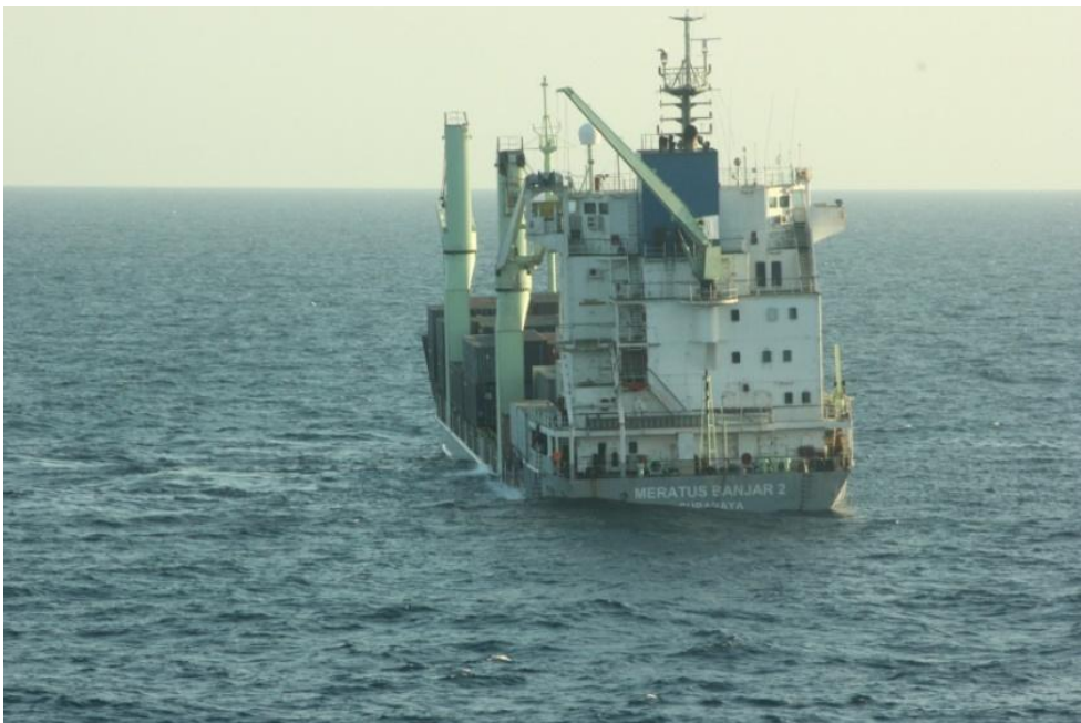
Gambar I.11: kondisi kapal pada pukul 17.05 WITA tampak kapal mengalami trim buritam
