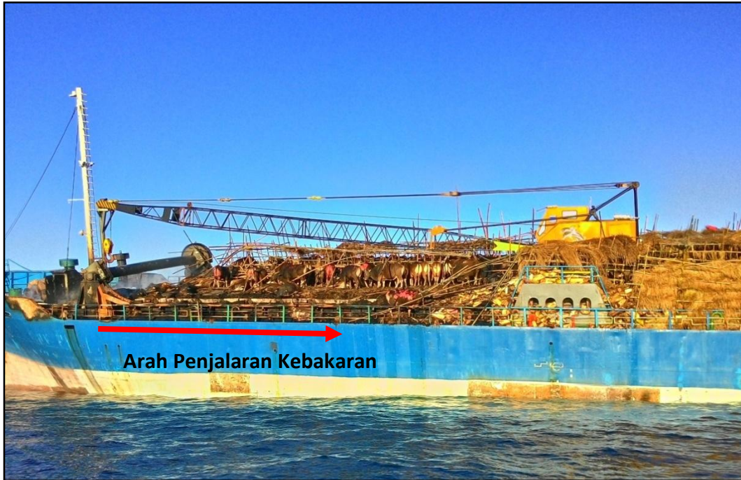
Gambar II-2: kondisi kapal setelah kebakaran.
