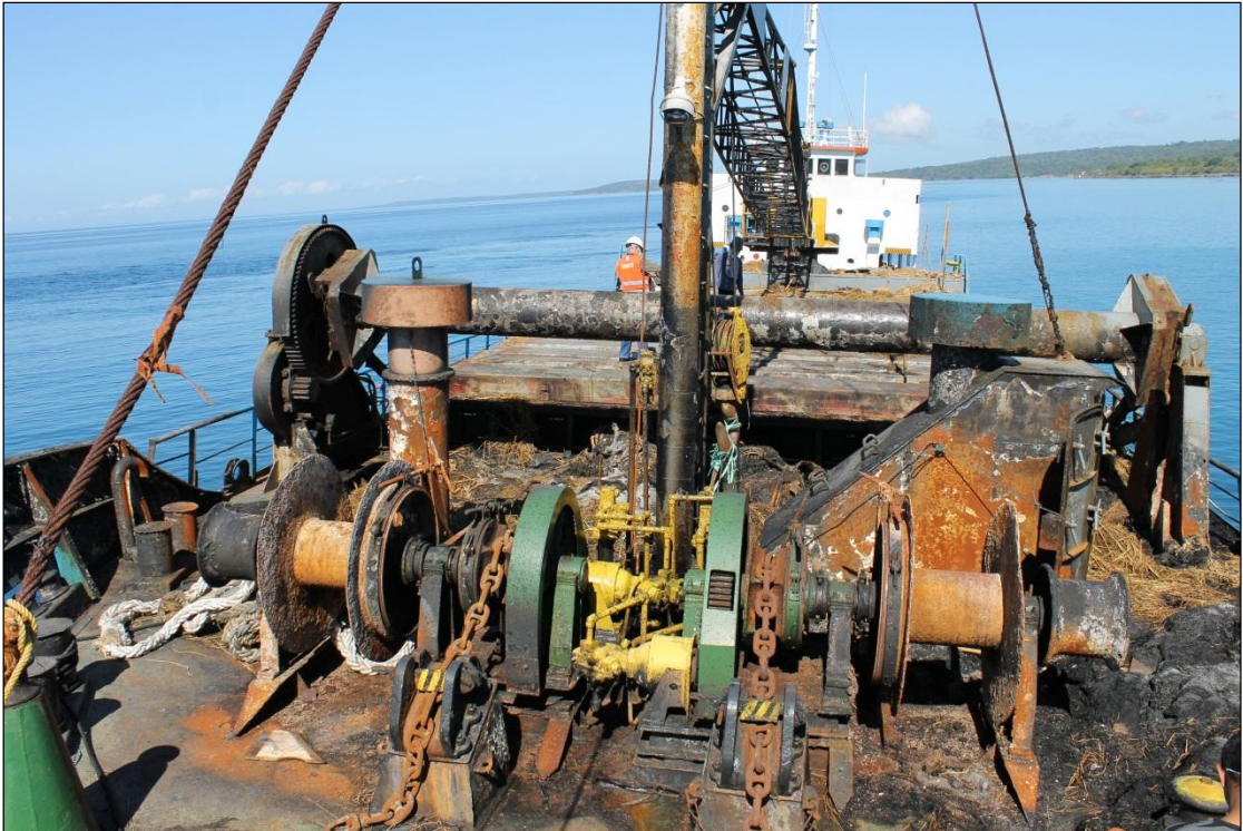
Gambar II-1: Bagian haluan kapal yang terbakar
