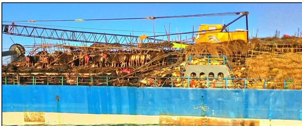
Gambar II-4: Struktur bambu yang terpasang di atas kapal untuk mendukung angkutan ternak hidup
