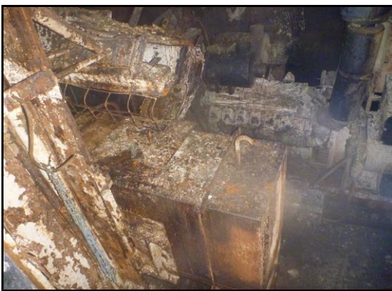
Gambar I-6: Kondisi mesin emergency generator setelah terbakar
