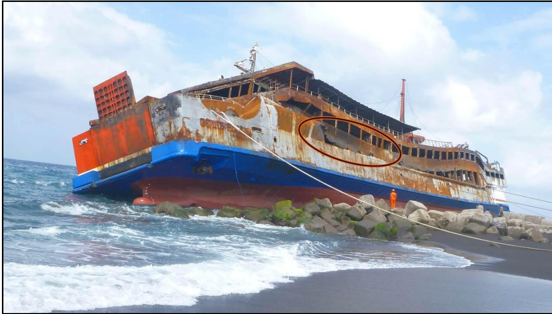
Gambar II-2: Area awal kebakaran (tanda lingkaran)
