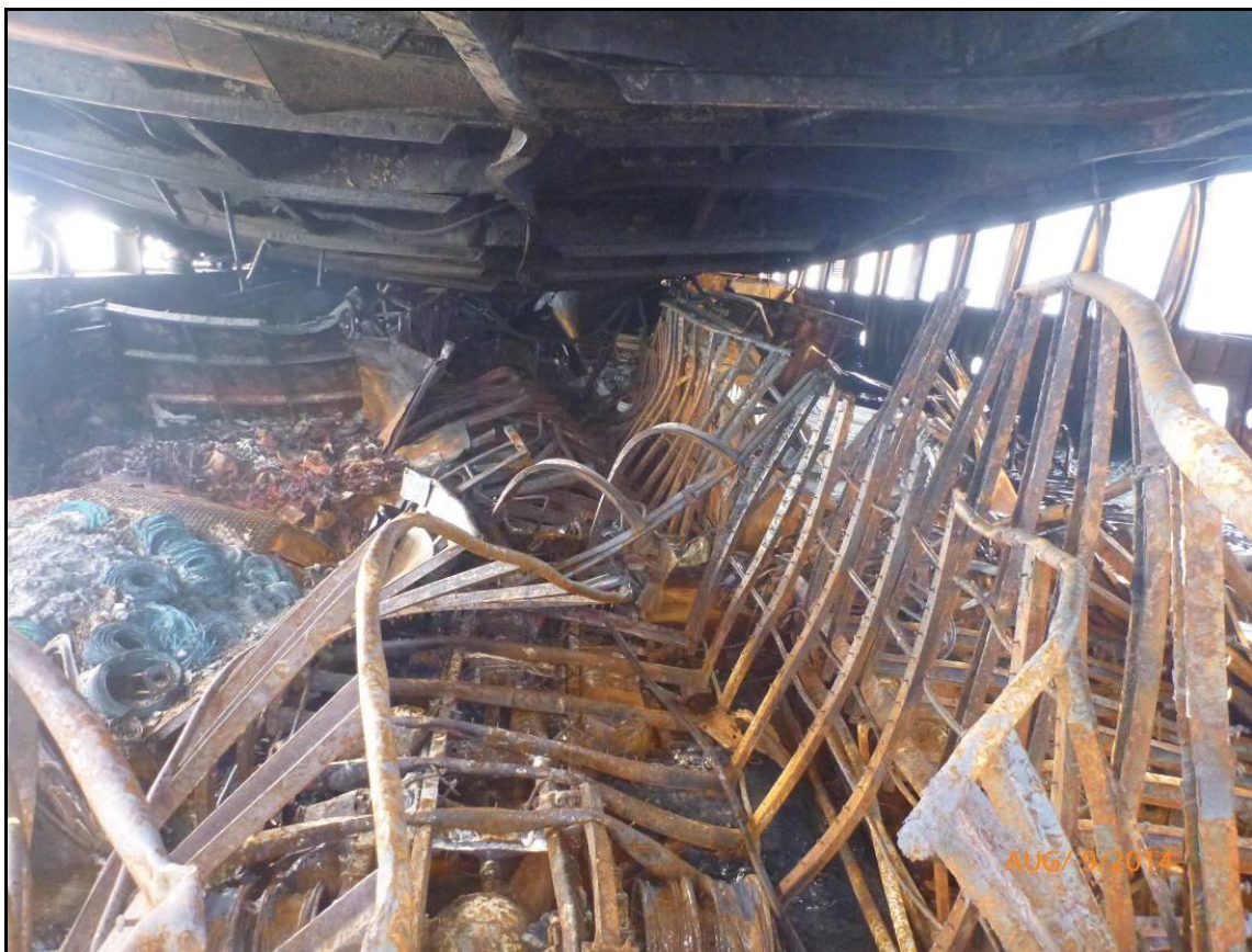
Gambar I-8: Kerusakan kendaraan di geladak kendaraan dilihat dari buritan kapal
