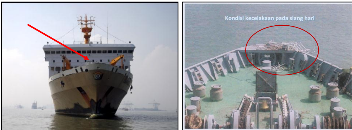
Gambar I-11: Kerusakan pada KM. Lambelu akibat ditubruk KM. Journey
