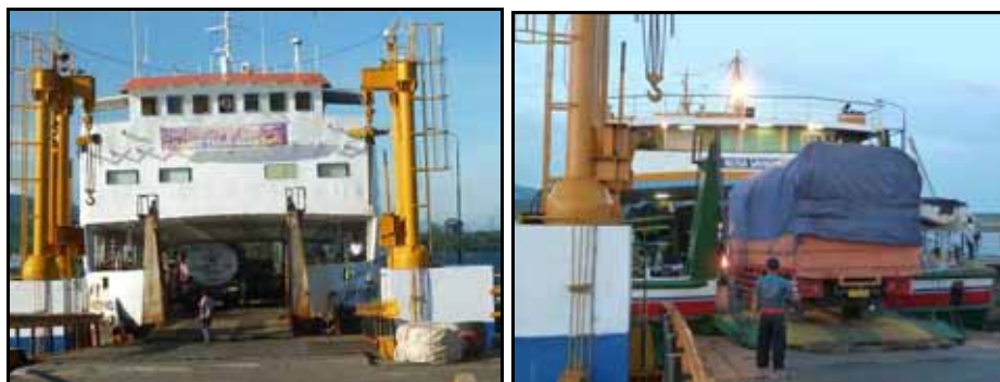
Gambar II-4: Kondisi rampa kapal dan jembatan bergerak pada beberapa kapal Pelabuhan Kayangan
