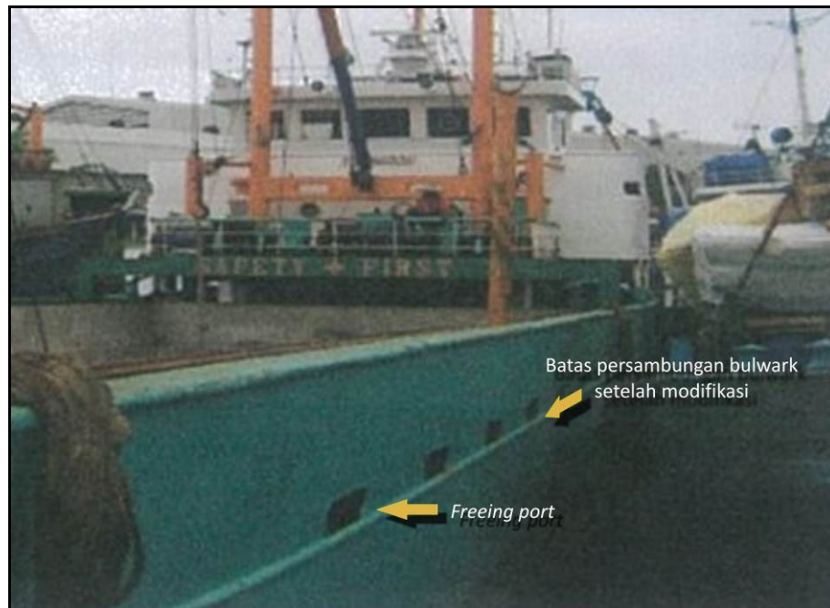
Gambar II-1: Modifikasi railing menjadi bulwark pada KM. Irama Nusantara
