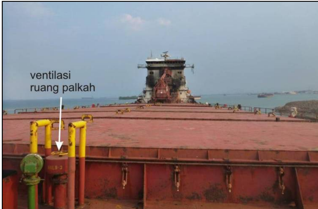
Gambar II-3: Posisi ventilasi ruang palkah dan loop
