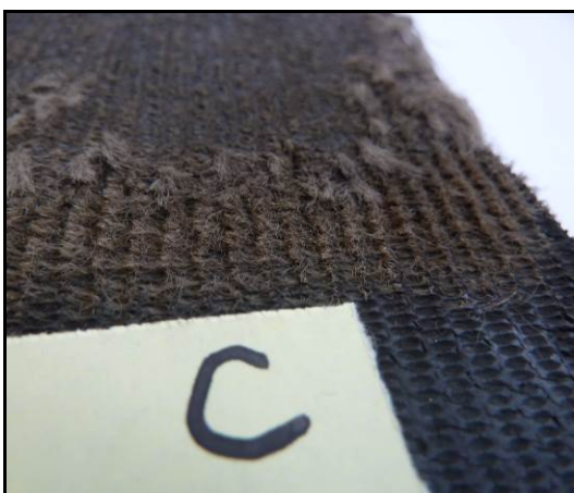
Gambar II-6: Kondisi sampel karet konveyor KM. Pramudita yang tidak terbakar
