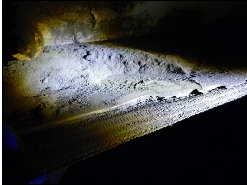
Gambar II-9. Sisa muatan batu bara di celah antara konveyor bagian atas (top) dan bawah (bottom)
