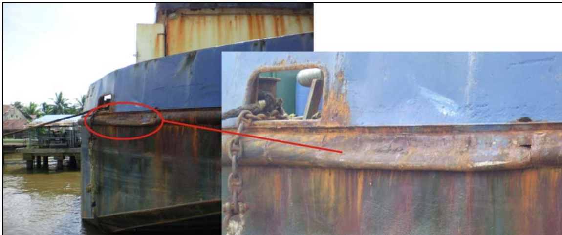
Gambar I-9: Kerusakan pada pisang-pisang haluan kanan TK. Anggada II
