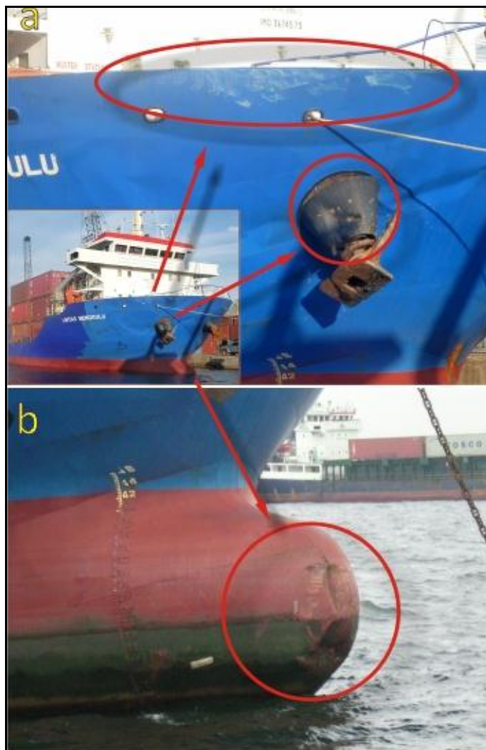
Gambar I-11: Kerusakan pada KM. Lintas Bengkulu di (a) ulup jangkar & railing kanan dan (b) bulbous bow
