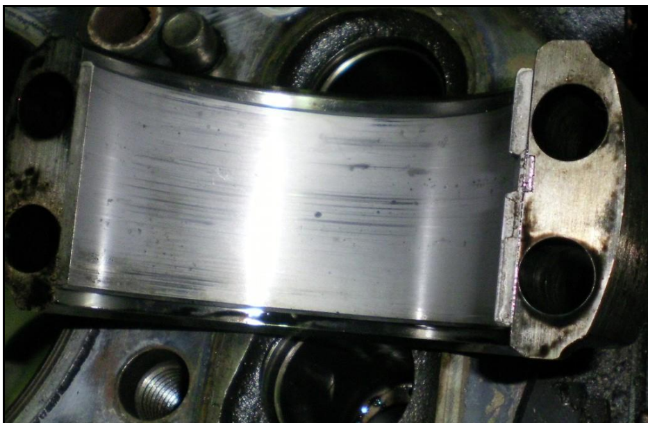
Gambar II-1: Kondisi Bearing Mesin Pompa Muatan no. 3
