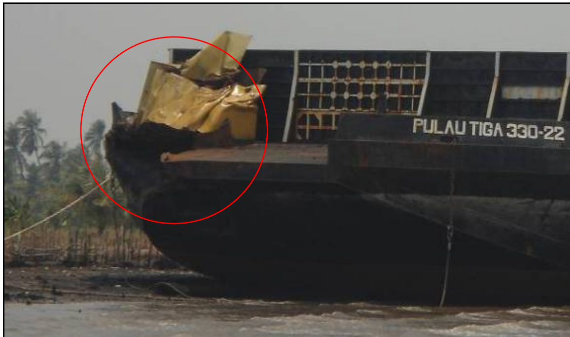
Gambar II-5: Kondisi kerusakan haluan kanan TK. Pulau Tiga 330-22
