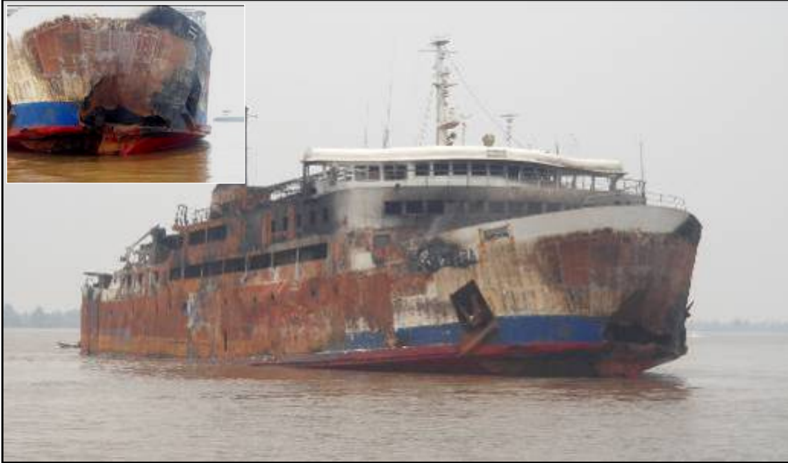
Gambar II-4: Kondisi kerusakan KM. Marina Nusantara setelah tubrukan dan terbakar
