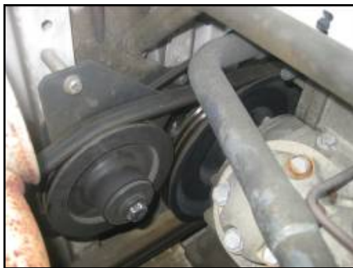
Gambar III-8: a. V-belt dan pulley penghubung putaran mesin diesel; b. kabel di sekitar mesin diesel
