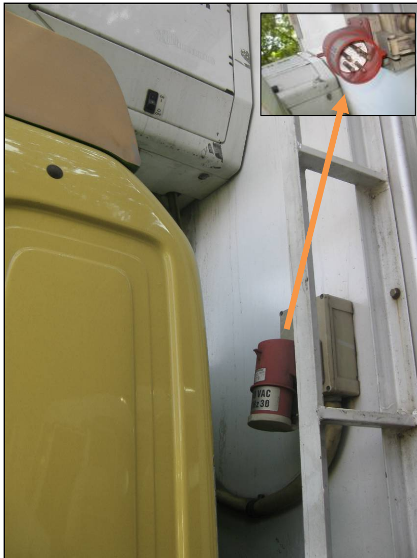
Gambar III-6: Posisi Plug listrik yang berada di sela antara kepala truk dengan box muatan
