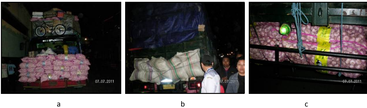
Gambar III-12: Kondisi muatan berlebih pada: (a) Bagian depan dan atas truk; (b) Bagian belakang truk; dan (c) Bagian bawah truk.
