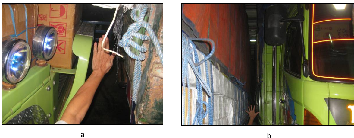
Gambar III-14: Kondisi jarak antarkendaraan di Lower car deck: (a) Depan-belakang; dan (b) Sisi kendaraan.
