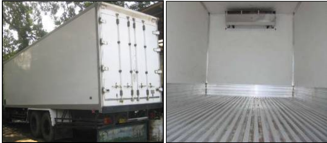
Gambar III-7: Contoh konstruksi box muatan dan ruang muatan
