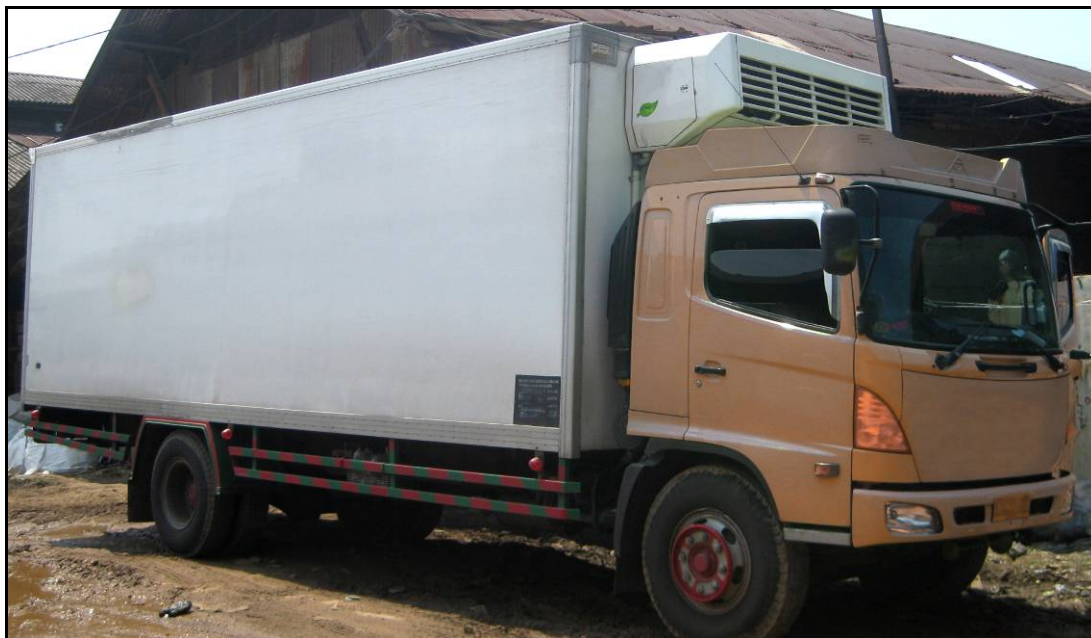
Gambar III-1: Truk dengan sistem pendingin yang sejenis dengan truk yang diindikasikan sebagai sumber awal kebakaran di KM. Musthika Kencana II
