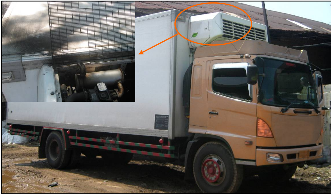
Gambar III-9: Posisi lubang buangan exhaust mesin diesel yang mengarah ke atas box muatan
