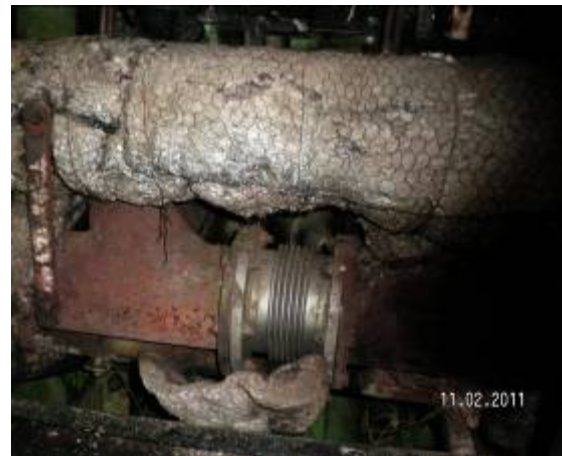
Gambar I-6: Keadaan manifold gas buang mesin induk kiri pasca kebakaran.
