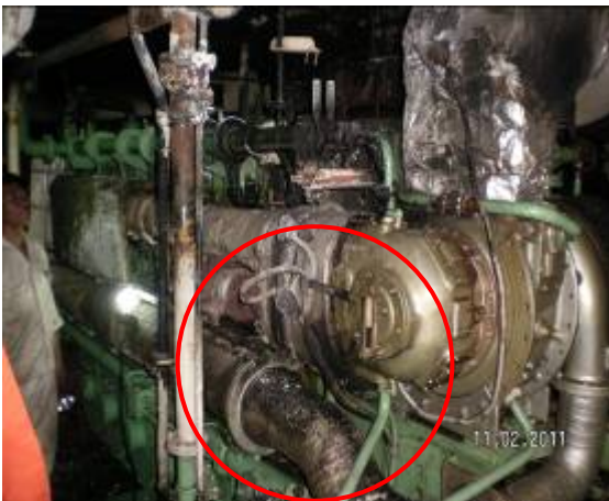
Gambar I-6: Keadaan manifold gas buang mesin induk kiri pasca kebakaran.
