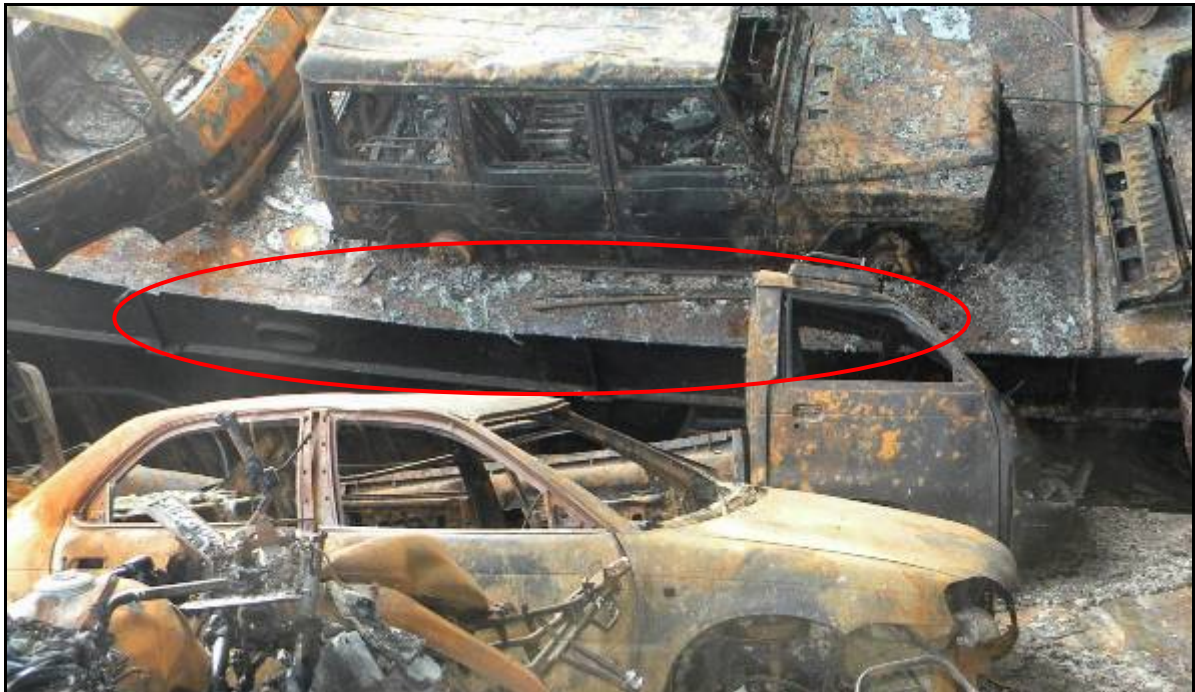
Gambar III-3: Kondisi sambungan pada pelat geladak Upper car deck yang mengalami runtuh
