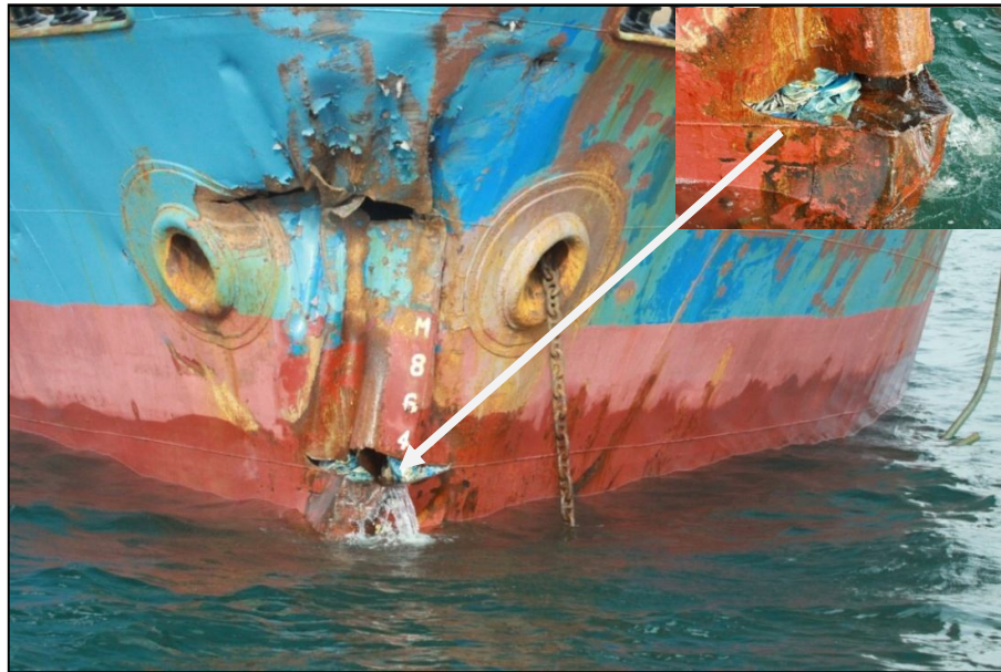
Gambar I-4 Kerusakan KM. Indimatam V pada bagian haluan
