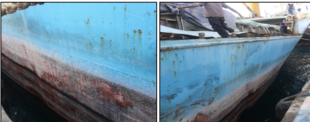
Gambar I-4 Kerusakan akibat tubrukan pada KM. Bosowa VI di bagian lambung kanan
